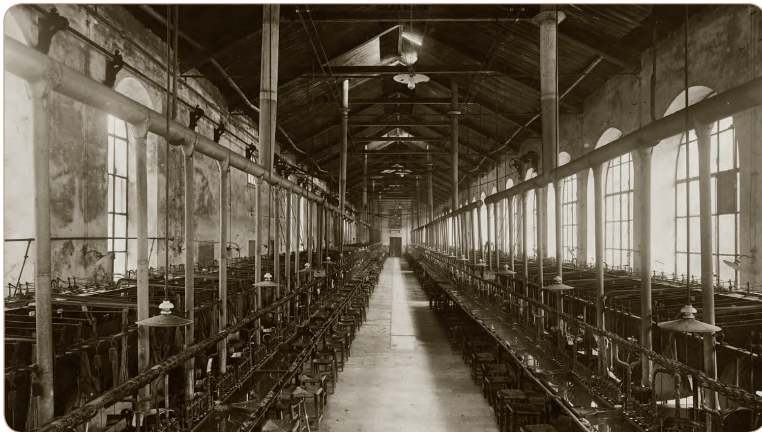
9. La galleria della filanda di Caprino come appariva agli inizi del Novecento con le numerose postazioni di lavoro e la disposizione delle relative bacinelle
