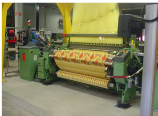
Immagine 3.18: Telaio operato a dispositivi jacquard per tessuti
