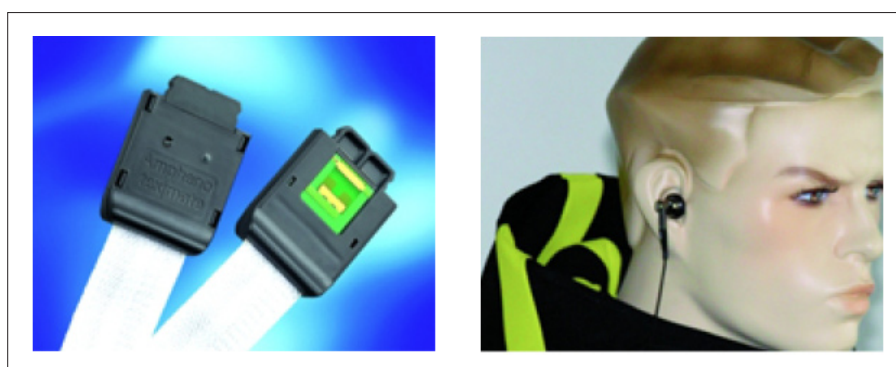
Immagine 3.30: A sinistra, il dispositivo di connessione Novonic, e a destra cuffia integrata alla giacca
