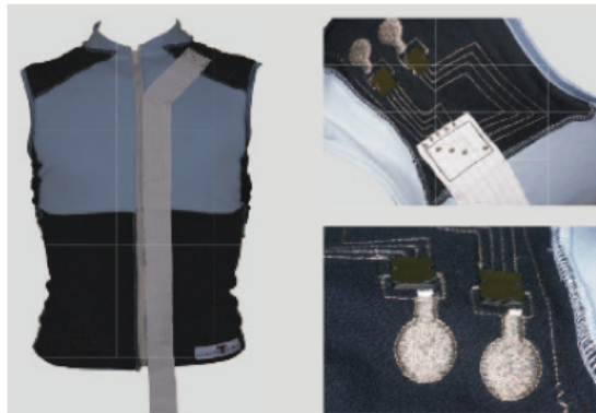
Immagine 3.32: Gilè per monitoraggio del stress, con sistemi di elettrodi applicati al tessuto
