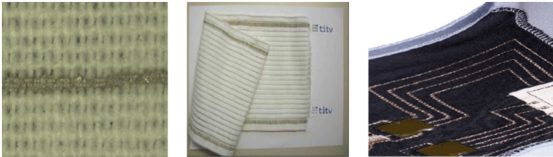
Immagine 4.3: Tipi di cavi: a sinistra stampato con inchiostro conduttivo, in centro tessuto con fili conduttivi e a destra tessuto ricamato con fili conduttivi.
