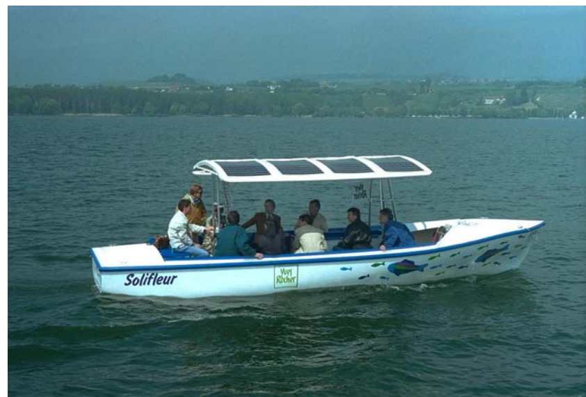
[71] Barca alimentata dal tessuto con i moduli FV integrati.
