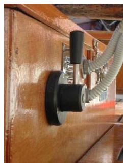
[83] Il Joystick con in quale si controlla la velocità del motore
