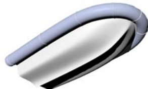
[166] Figura dimostrativa di un gommone semi-rigido con la carena a forma dislocante/planante
