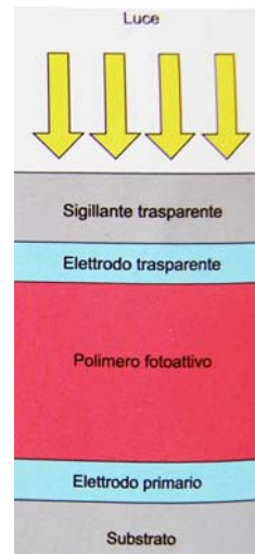
[62] La struttura della power plastic (riprodotta da Konarka)
