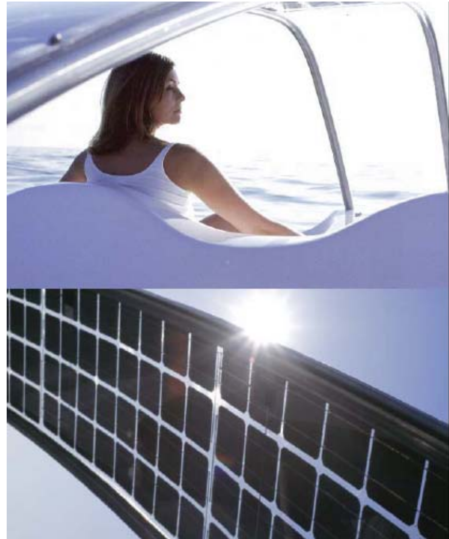
[5] Immagine della barca SOL10 completamente autonomo ad energia solare con i pannelli fotovoltaici installati
