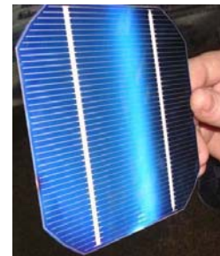
[36] Cella solare, costituita da un wafer in silicio monocristallino
