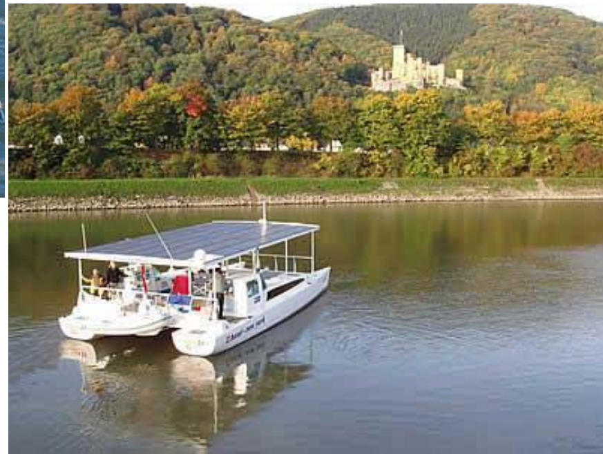
[8] Immagine di una barca a forma di catamarano per i gruppi di turisti, alimentata dai moduli fotovoltaici per un'uso previsto nelle acque protette.
