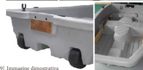
[169] Immagine dimostrativa dell'imbarcazione rigida con la carena a forma di catamarano - Tender 245
