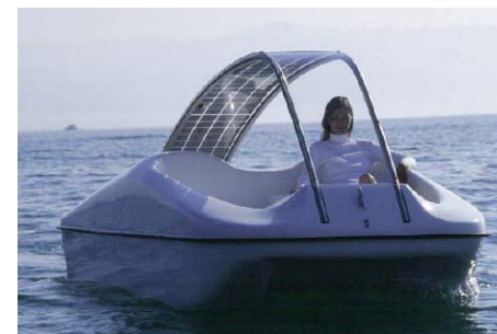
[32] Barca "SOL 10" completamente alimentata ad energia elettrica proveniente dai moduli fotovoltaici installati sul telaio superiore dell'imbarcazione (Potenza motore: 550 W Motore fuoribordo 12V con pannelli solari da 210 Wp alimentati da 4 batterie da 6V ognuno con la capacità di 200 Ah per la singola batteria).
