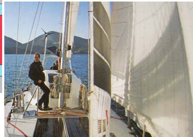
[63] Barca con motore ibrido (diesel-elettrico) co-alimentato da elettricità solare
