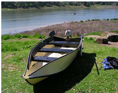
[150] Immagine della barca Porta-Bote Genesis 10ft. model progettato completamente con le parti componibili e smontabili per facilitarne il trasporto. La barca è premiata.
