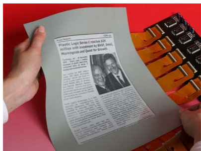
[30] Il primo display flessibile ad alta leggibilità basato su tecnologia OLED è prodotta in serie presso l'impianto di Dresda della Plastic Logic: www.plasticlogic.com .
