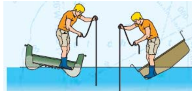
[173] figura dimostrativa che mette in confronto gli scafi a forma V e gli scafi a forma di catamarano. Lo scafo a forma di catamarano risulta senza dubbio più stabile e
