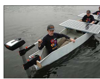
[77] Barca di gara alimentata ad energia solare con il motore elettrico
