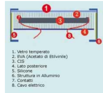
[58] Strati del pannello solare in silicio semicristallino
