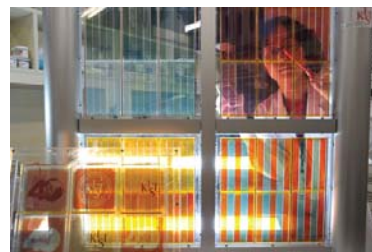
[64] Un'immagine delle celle solari a colorante sviluppato in ambito di laboratorio
