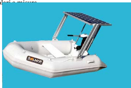
[69] Gommone con i pannelli solari installati tramite un telaio di acciaio INOX
