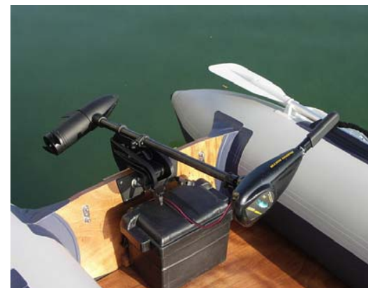
[90] A 12 volt motore elettrico fuoribordo montato uslla poppa del gommone
