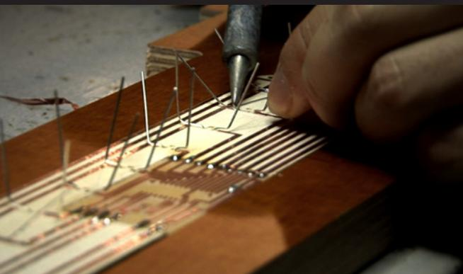
9. saldatura dei led sulla scheda in legno e rame.
