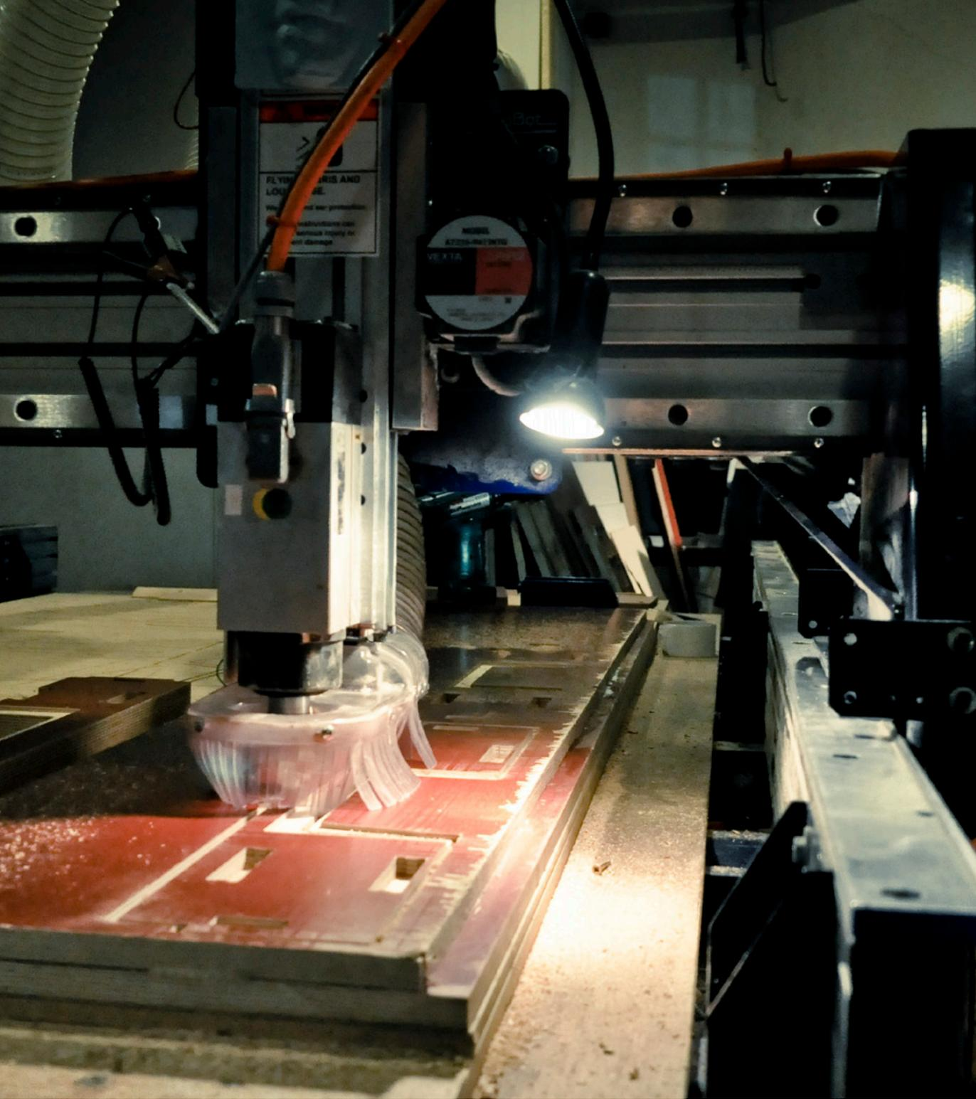
Fig. 22 - Una fresatrice CNC Shopbot in azione al Fab Lab di Amsterdam
