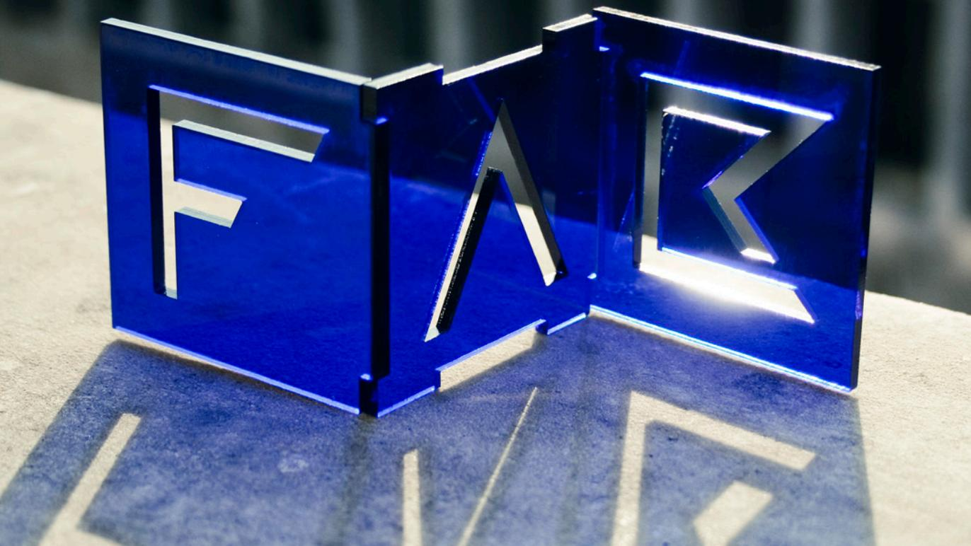
Fig. 59 - Una esempio di tipografia tridimensionale costruita con moduli di acrilico tagliati a laser.
