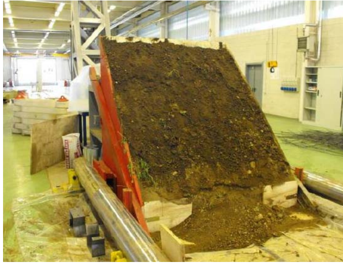
Figura 1.4 Terrapieno utilizzato nell'esperimento del Politecnico
