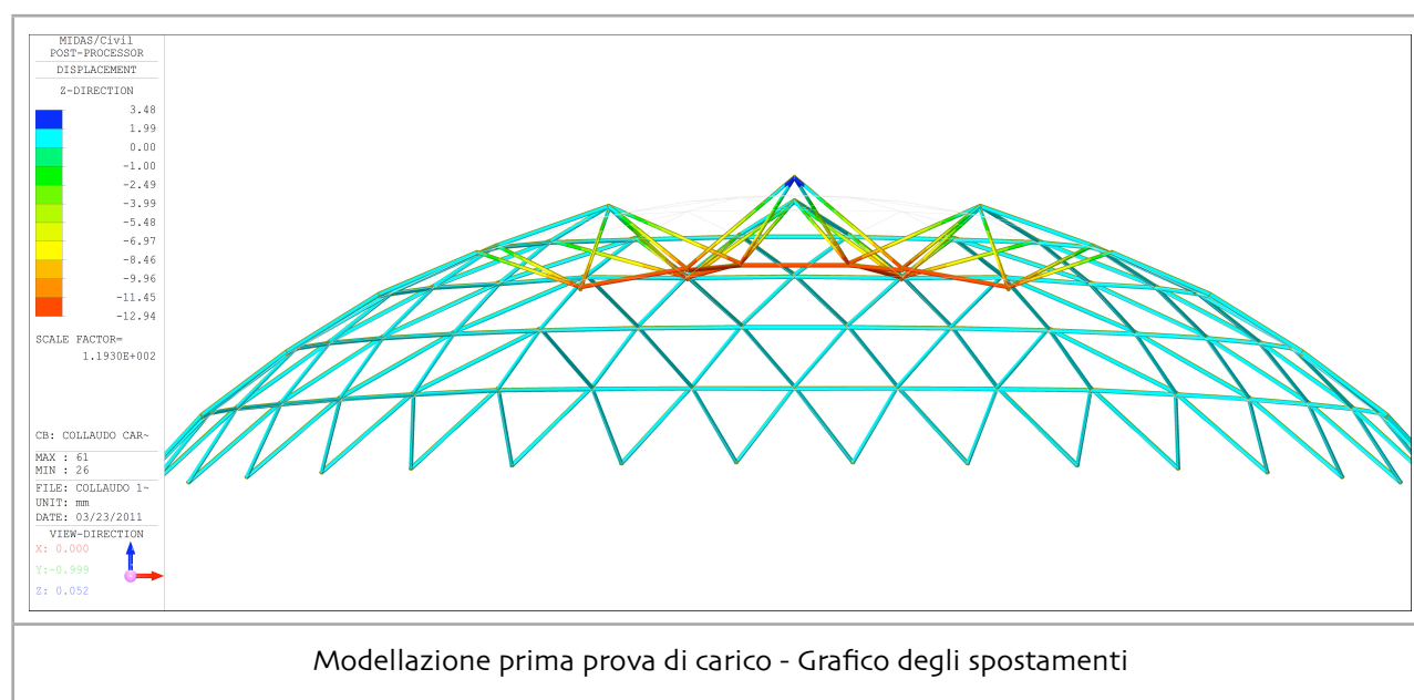
Fig. 10.6 - Risultati del modello della prima prova di carico
