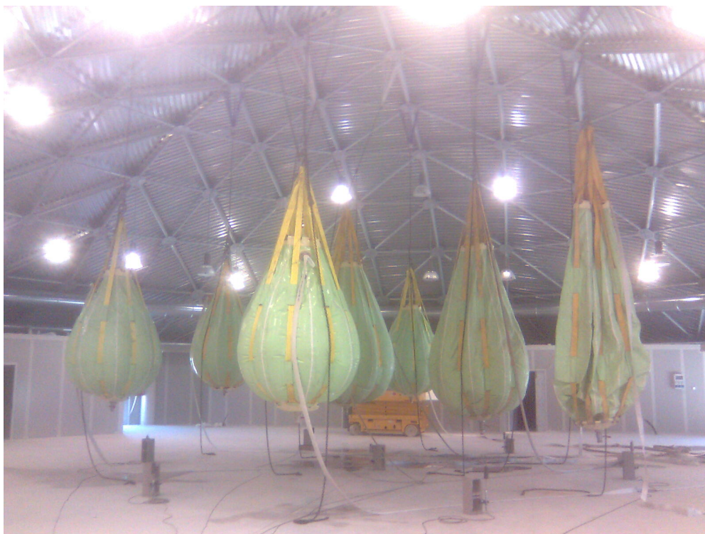
Fig. 10.5 - Immagine della prima prova di carico
