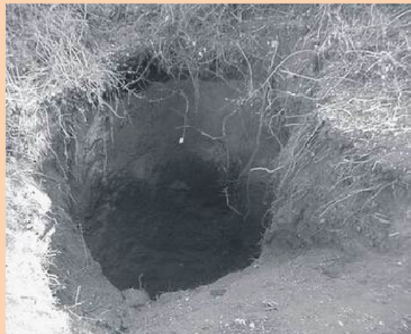
Figura 2.49: Manifestazione in superficie dell'intercettazione di una cavità carsica con lo scavo della galleria Dodoni (Török et Al. 2006).
