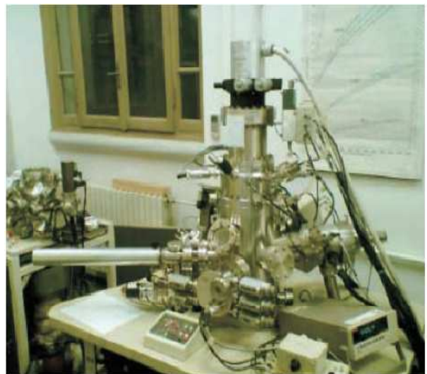
Figura 4.4: Schema delle ottiche elettroniche di un microscopio SAM (4.4a) e foto SAM PHI 660 in dotazione al Dipartimento di Fisica del Politecnico di Milano (4.4b).
