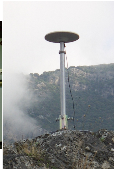
Figura (1.7) Il sostegno dell'antenna ricevente e l'antenna montata
