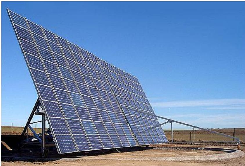
Figura 1-9 *Inseguitori azimut-elevazione*
