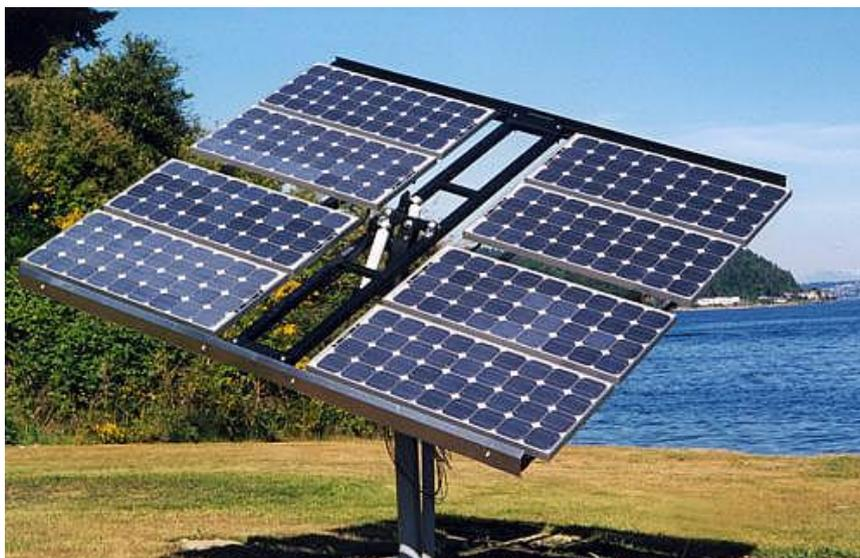
Figura 1-6 *Inseguitori di Azimut*
