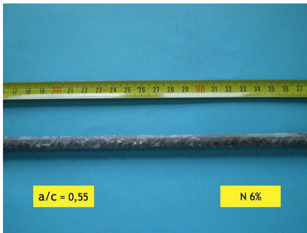
Calcestruzzo armato con inibitore a base di nitrato al 6%*
