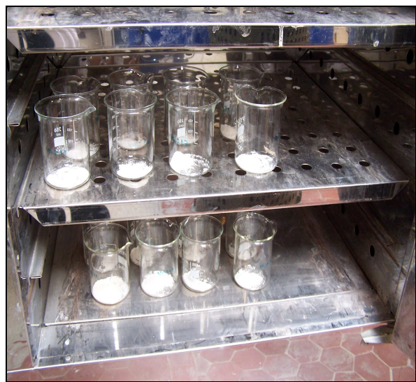
Figura 3.12 – Essiccamento della polvere di calcestruzzo
