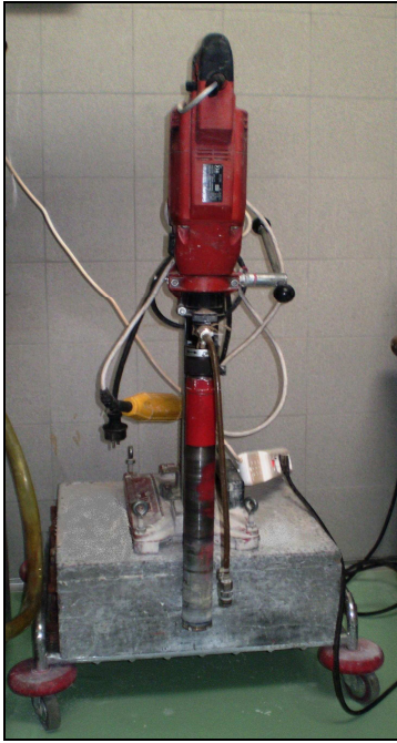
Figura 3.9 – Carotatrice a colonna raffreddata ad acqua
