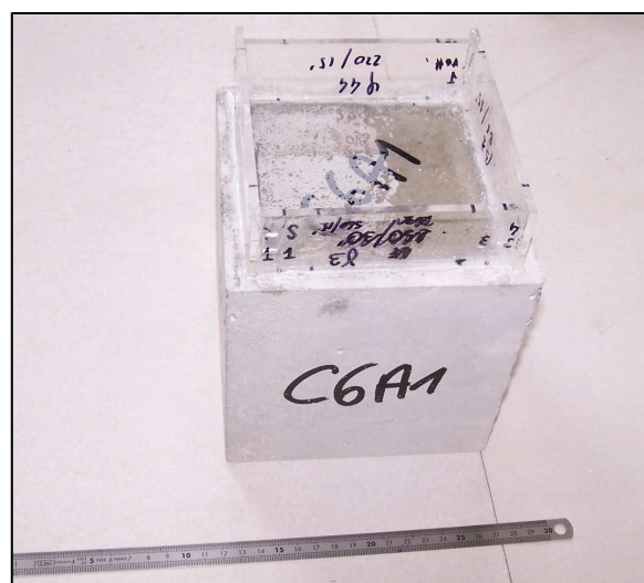
Figura 3.5 - Provino cubico per prove di ponding
