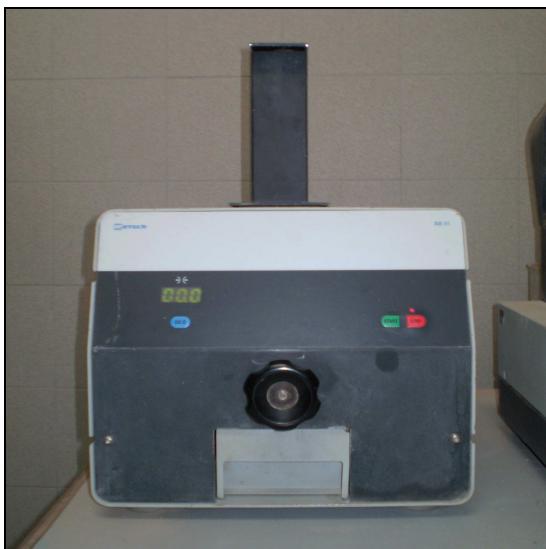
Figura 3.11 – Mulino a ganasce per la polverizzazione del calcestruzzo
