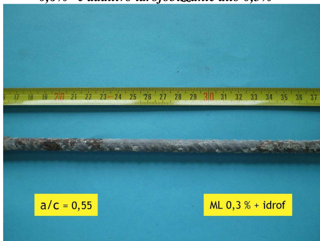
Calcestruzzo armato con inibitore organico M-L allo 0,3%* e additivo idrofobizzante allo 0,5%*
