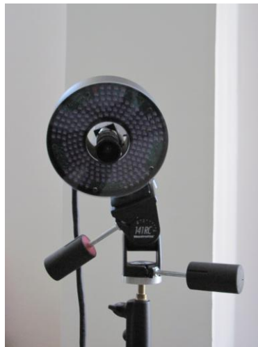
Figura 13: telecamera con emettitori LED a infrarossi.
