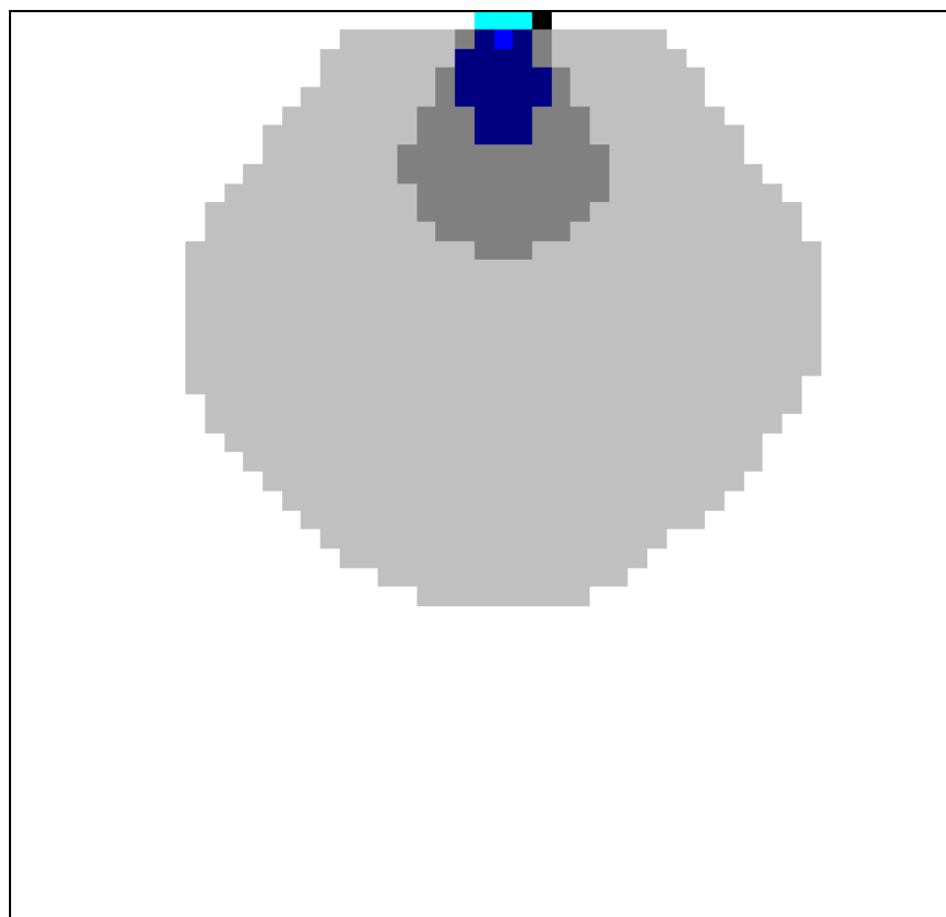
Figure 3.37 e 3.38 – Propagazione dell'onda di figura 3.3 al tempo t = 500 s, ottenuta dal codice di calcolo numerico con schema MacCormack per passo temporale \Delta t = 0.01 s (in alto) e \Delta t = 1 s (in basso).
