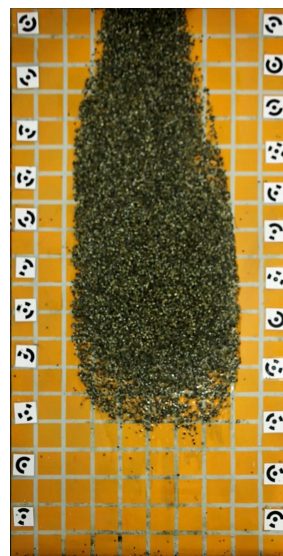
Prova con miscela di ghiaia satura t = 1.933 \text{ s} L = 1.51 \text{ m}
