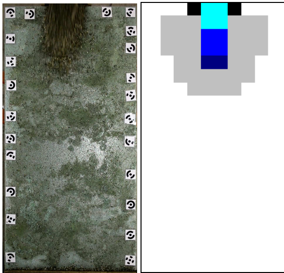
t = 0.400 \text{ s} Onda sperimentale: L = 0.40 \text{ m} Onda numerica MacCormack: L = 0.6 \text{ m}
