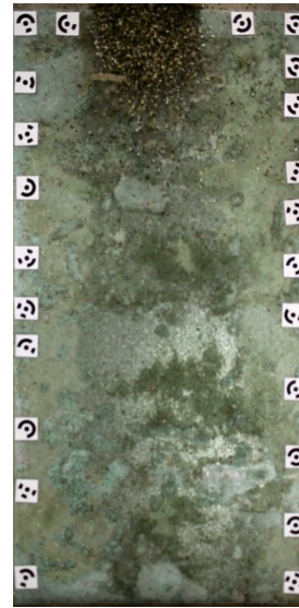
Prova con miscela di ghiaia satura t = 1.633 \text{ s} L = 0.31 \text{ m}
