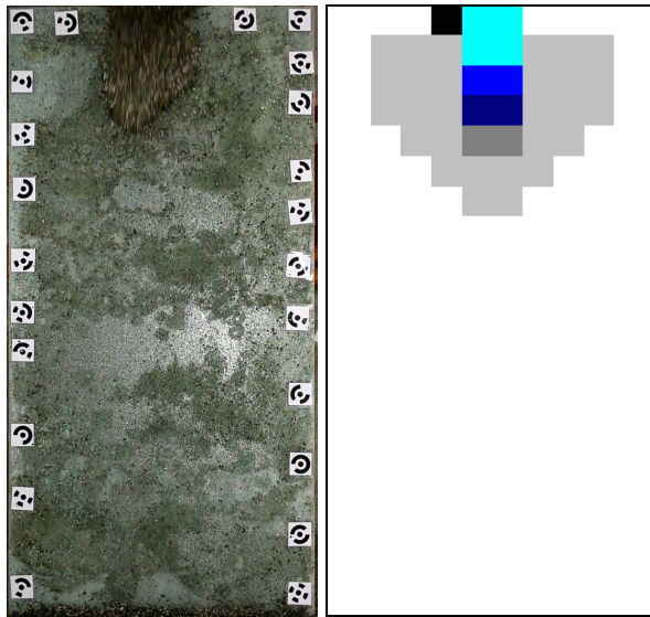
t = 0.467 \text{ s} Onda sperimentale: L = 0.43 \text{ m} Onda numerica MacCormack: L = 0.6 \text{ m}
