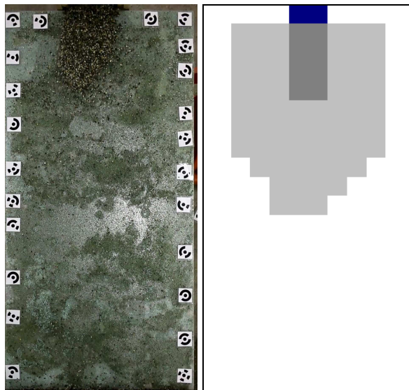
t = 1.033 \text{ s} Onda sperimentale: L = 0.45 \text{ m} Onda numerica MacCormack: L = 1.0 \text{ m}
