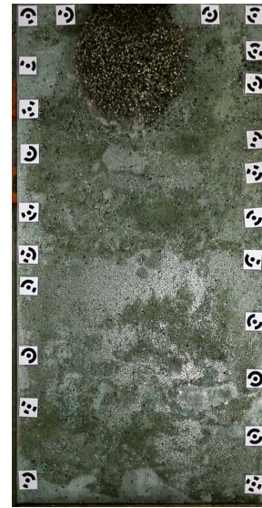
Prova con miscela di ghiaia satura t = 1.300 \text{ s} L = 0.48 \text{ m}
