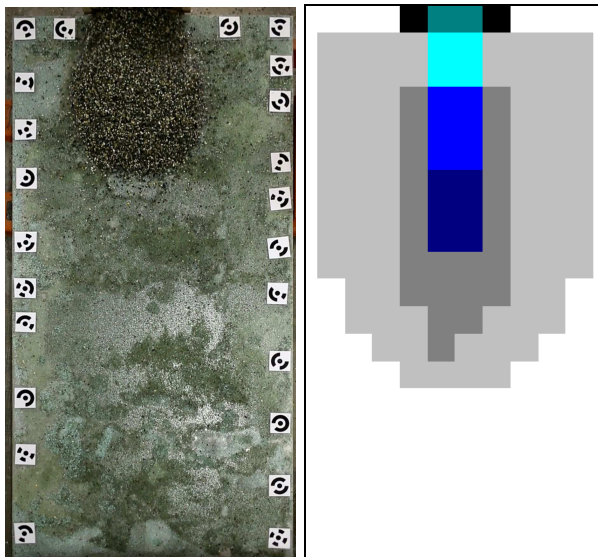
t = 1.533 s Onda sperimentale: L = 0.64 m Onda numerica MacCormack: L = 1.3 m
