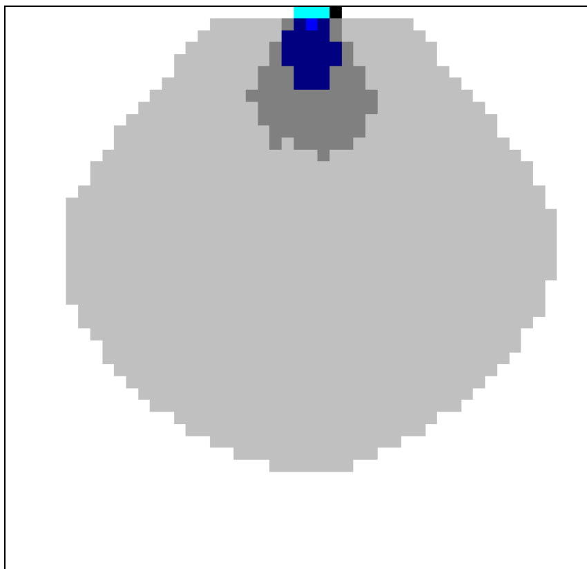
Figure 3.39 e 3.40 – Propagazione dell'onda di figura 3.3 al tempo t = 600 s, ottenuta dal codice di calcolo numerico con schema MacCormack per passo temporale \Delta t = 0.01 s (in alto) e \Delta t = 1 s (in basso).
