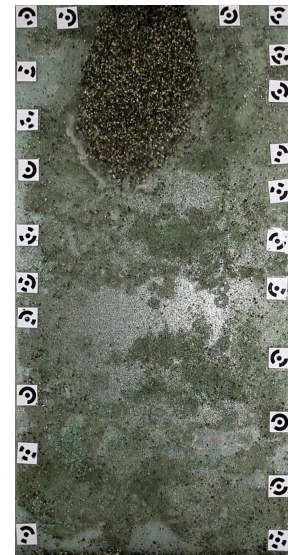
Prova con miscela di ghiaia satura t = 1.900 \text{ s} L = 0.64 \text{ m}
