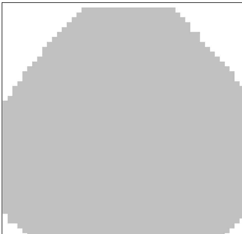
Figure 3.45 e 3.46 – Propagazione dell'onda di figura 3.3 al tempo t = 1000 s, ottenuta dal codice di calcolo numerico con schema MacCormack per passo temporale \Delta t = 0.01 s (in alto) e \Delta t = 1 s (in basso).
