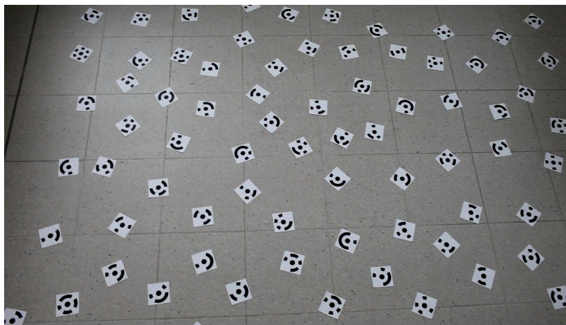
Figura 5.10 – Disposizione dei target per la calibrazione del dispositivo Canon EOS 5D in modalità filmato con obiettivo a focale fissa pari a 35 mm.
