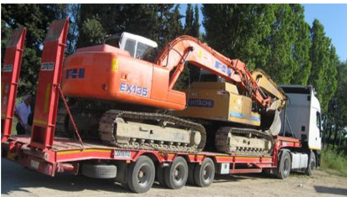
Fig. 3.12 – Bilico per movimentazione mezzi cingolati
