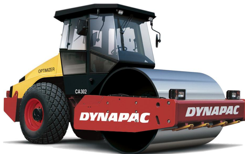
Fig. 2.15 – Rullo monotamburo dinamico 15t
