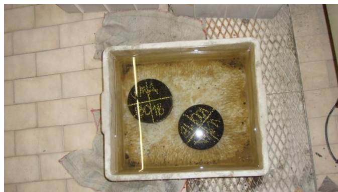
Figura 13 Provini a bagno nell'acqua
