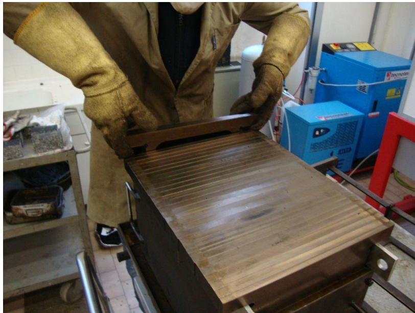
Figura 25 Inserimento delle Sliding Plates nello stampo
