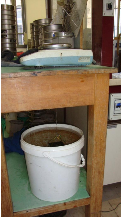
Figura 14 Bilancia con la quale viene effettuata la pesata idrostatica del campione
