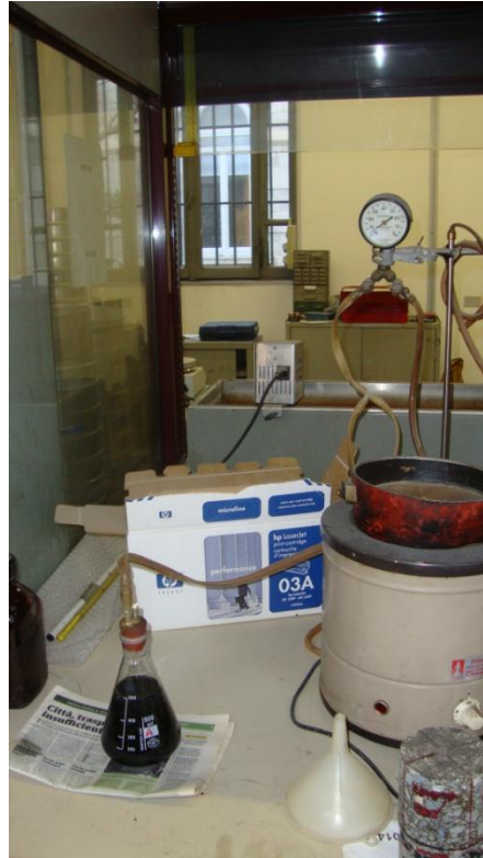
Figura 6 Picnometro riempito con miscela ed acqua distillate e collegato alla pompa
