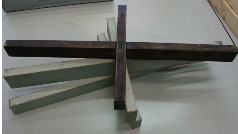
Figura 23 Distanziali con assemblaggio a croce
