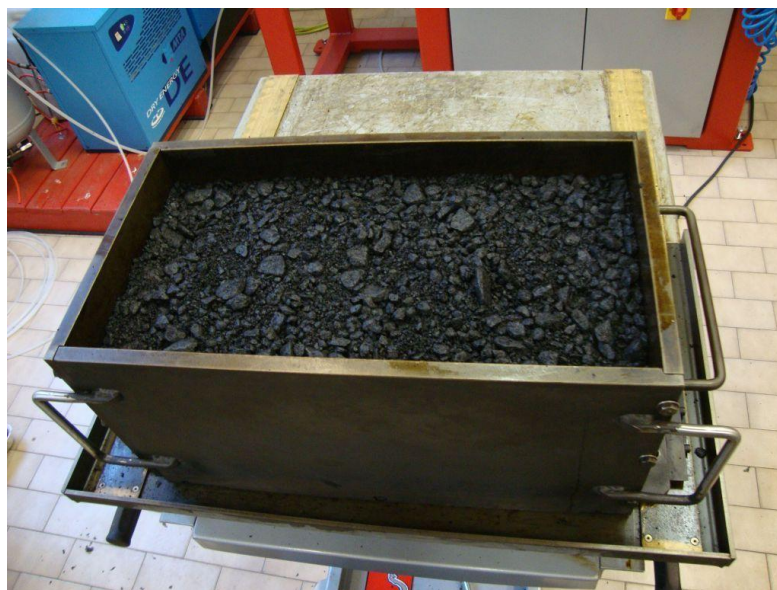
Figura 24 Stesa del materiale all'interno dello stampo
