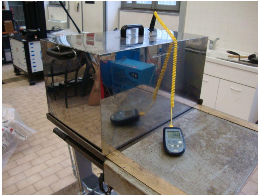
Figura 22 Riscaldamento dello stampo e controllo temperatura
