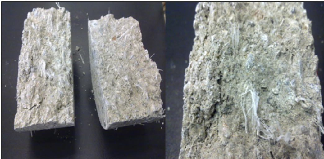
Figura 3.3 – Provino di MCF rotto tramite prova Brasiliana
