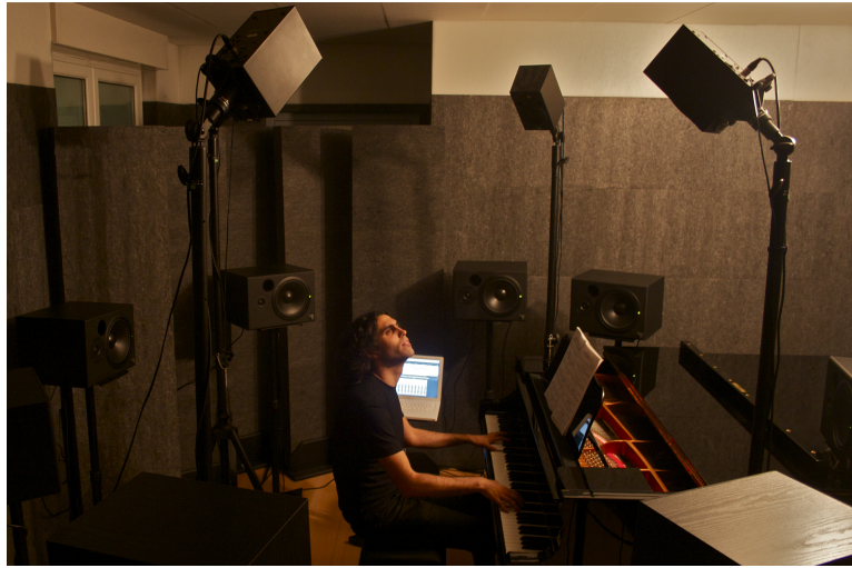
Figure 6.1: Ambisonics reproduction system installation in the recording room of the sound laboratory 'Laboratorio di Elaborazione e produzione dei segnali Audio e Musicali of 'Politecnico di Milano' in Como.
