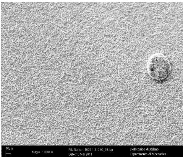
Fig. 5.66 – Aspetto dell'ossido di cromo a 1050°C per 1 ora. a) 1000x e b) 4000x.
