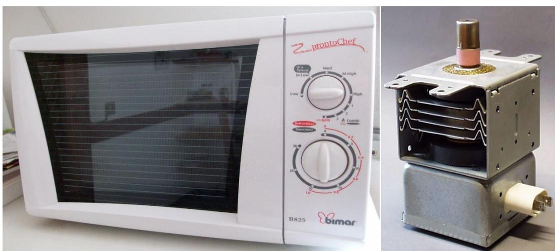
Figura 5.18 – Foto del microonde monitorato ed esempio di magnetron.
