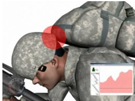
Figura 1.7. Santos: soldato virtuale utilizzato per testare l'ergonomia di equipaggiamento e armi
