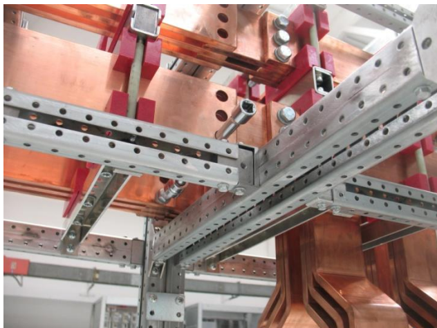
Figura 4.17. Prototipo della soluzione a 3 fori e prova dell'inserimento della prolunga
