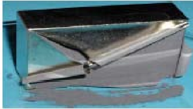
Figura 1.2 Effetto sulla placcatura in nichel dopo 20 ore a 130°C, 260 kPa e 95% di umidità
