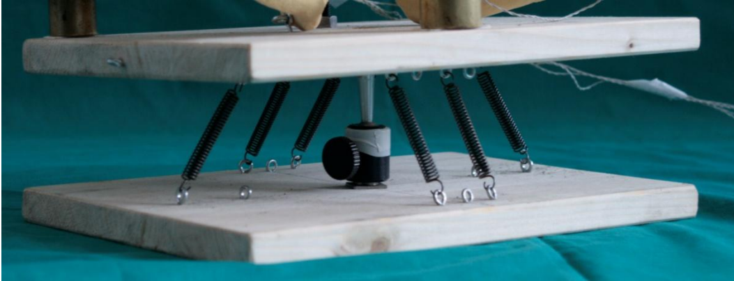
Figura 18 Dettaglio del modello fisico dei tessuti molli: vincolo sferico posto tra le due piattaforme di sostegno in legno e componente elastica del modello realizzata con coppie di molle a trazione.
