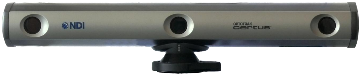
Figura 13 Sistema di localizzazione ottico Optotrak Certs (NDI, Ontario, Canada).
