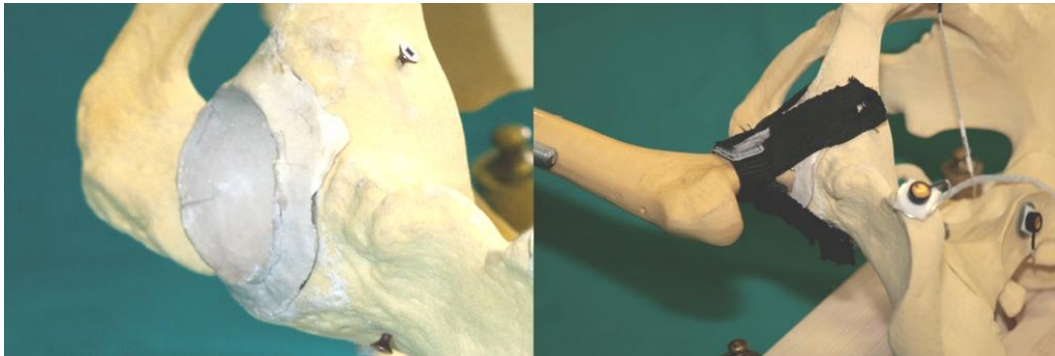
Figura 16 Dettagli del modello fisico dell'articolazione dell'anca: sx ) alloggio in DAS della testa femorale nella coppa acetabolare; dx ) gabbia elastica che mima la funzionalità legamentosa articolare.
