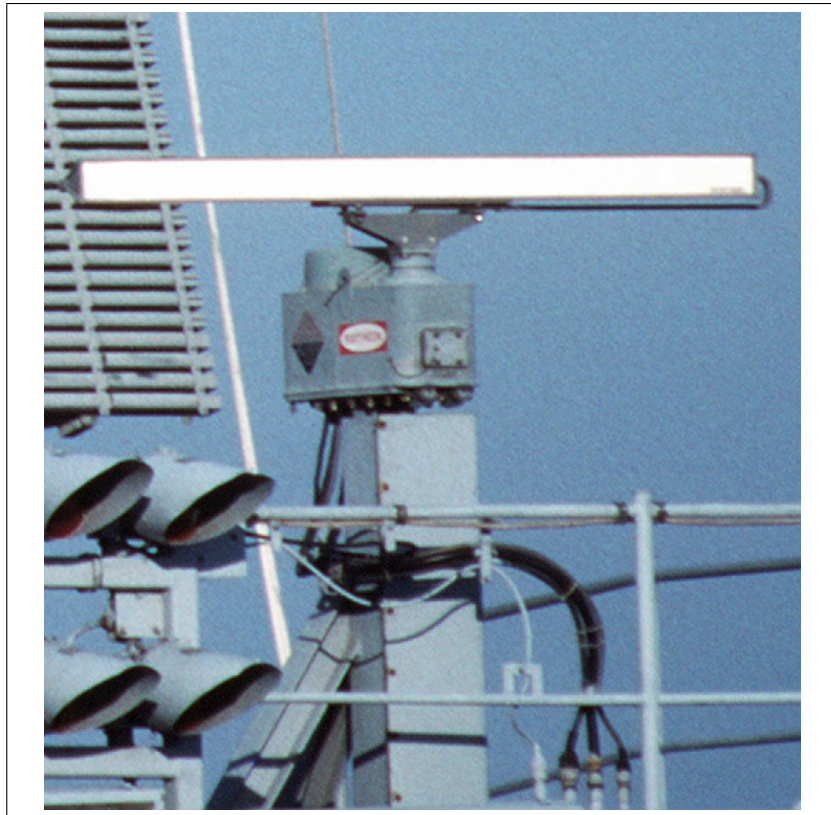
Figura 1.3: Radar con antenna rotante, maggiore risoluzione orizzontale e bassa risoluzione verticale.
