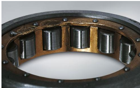
Figura 2.4 Tipico danneggiamento sulla gabbia di un cuscinetto volvente.
