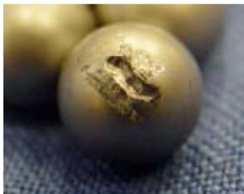
Figura 2.3 Tipico danneggiamento sull'elemento volvente.
