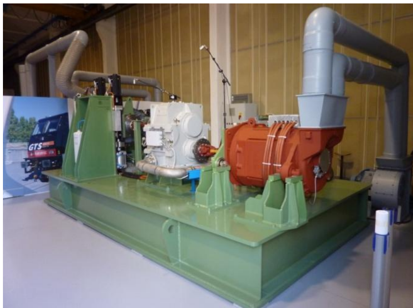
Figura 3.1 Banco prova per la simulazione del sistema di trazione del treno ad alta velocità.
