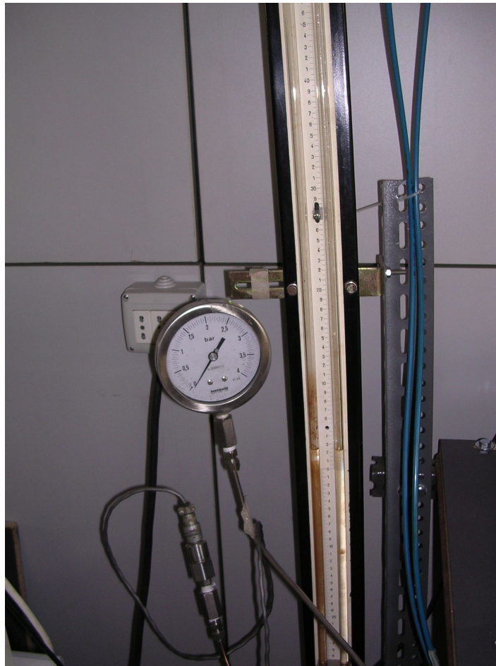
Figura 4.15: Colonna d'acqua per la lettura della caduta di pressione tra monte e valle dell'ugello calibrato.
