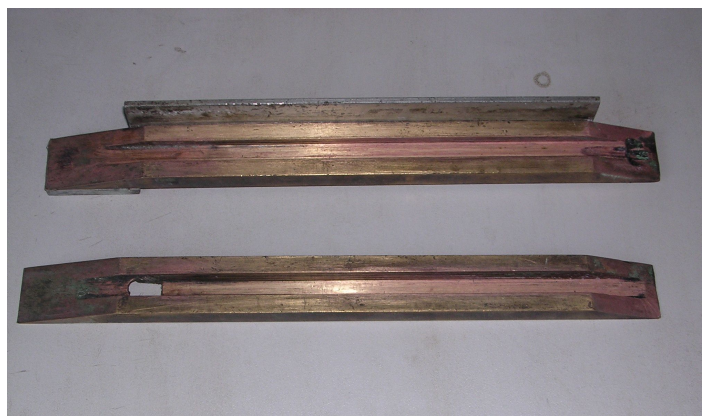
Figura 4.4: Portaprovino in ottone per la geometria slab.
