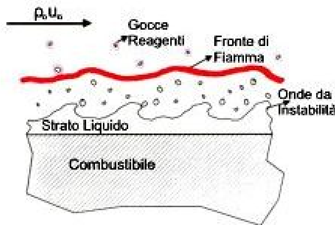
Figura 2.5: Schema del meccanismo instabilizzante dei combustibili bassofondenti.
