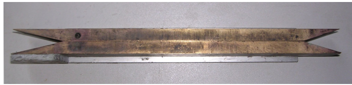
Figura 4.6: Portaprovino come si presenta una volta inserito in camera di combustione.
