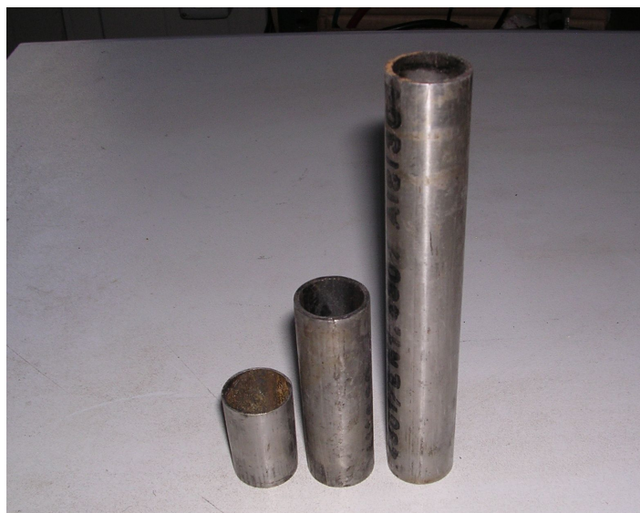
Figura 4.8: Cilindri portaprovino radiale (30, 56 e 125 mm).
