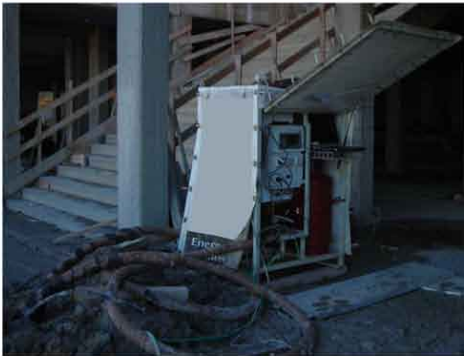
Figura 1: strumentazione per il Ground Response Test (immagine di repertorio)
