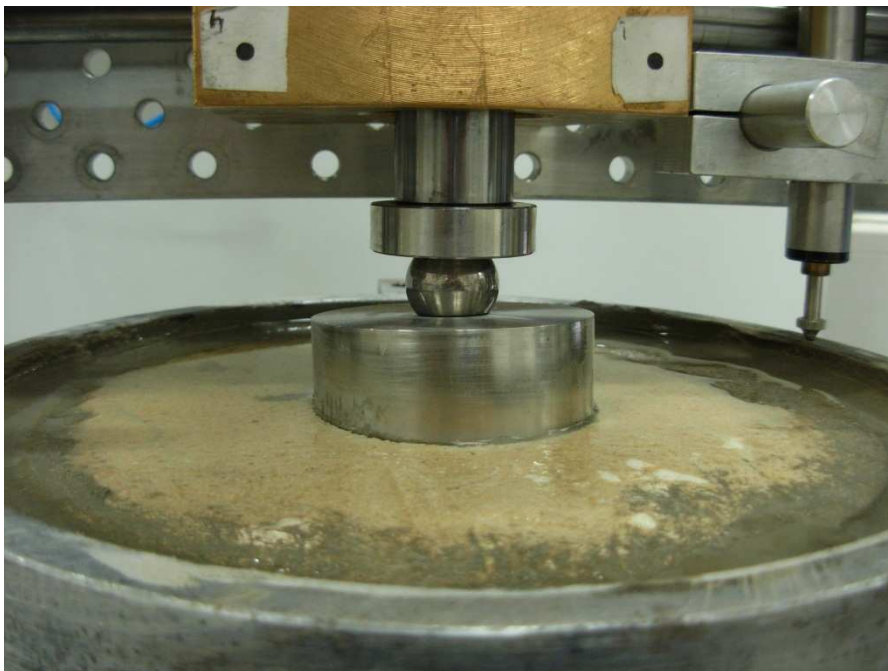
FIG. (58) – particolare fondazione inclinata
