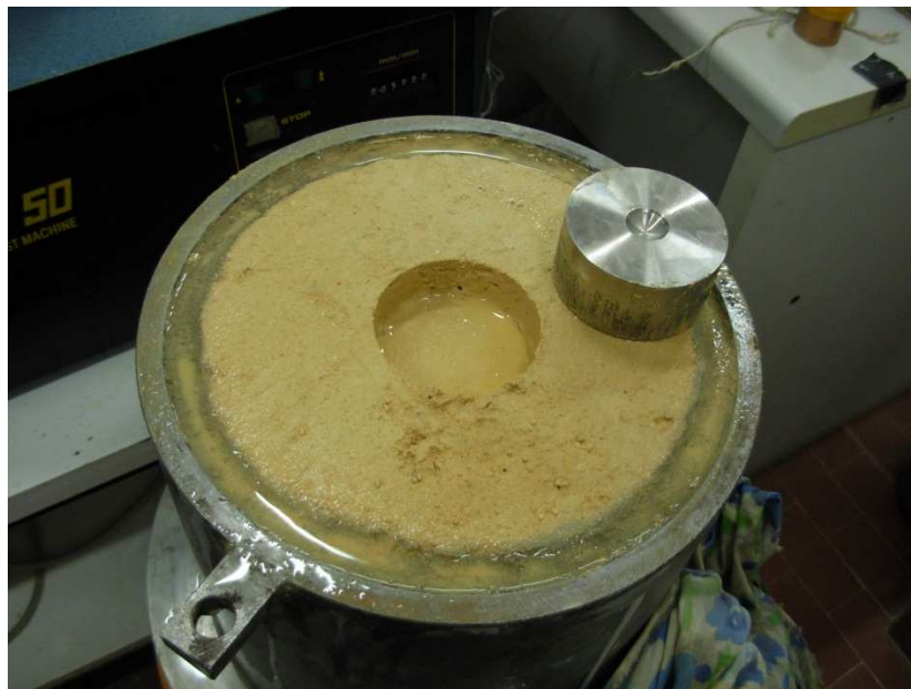
FIG. (69) – meccanismo di rottura superficiale del campione CCL-W-01-60
