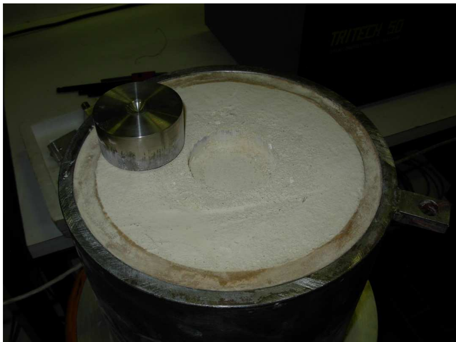
FIG. (56) – meccanismo di rottura superficiale nel caso secco
