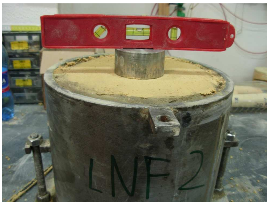
FIG. (53) – posa del modello di fondazione
