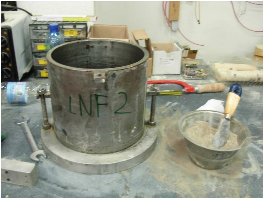
FIG. (47) – cassero in acciaio e preparazione del fondo con malta
