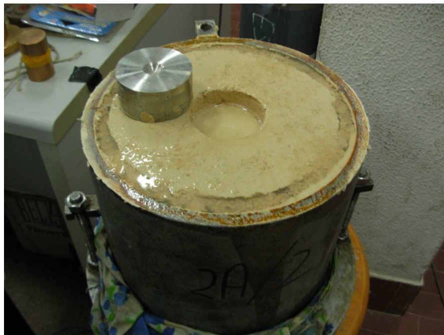
FIG. (77) – meccanismo di rottura superficiale del campione CCP-W-02-60
