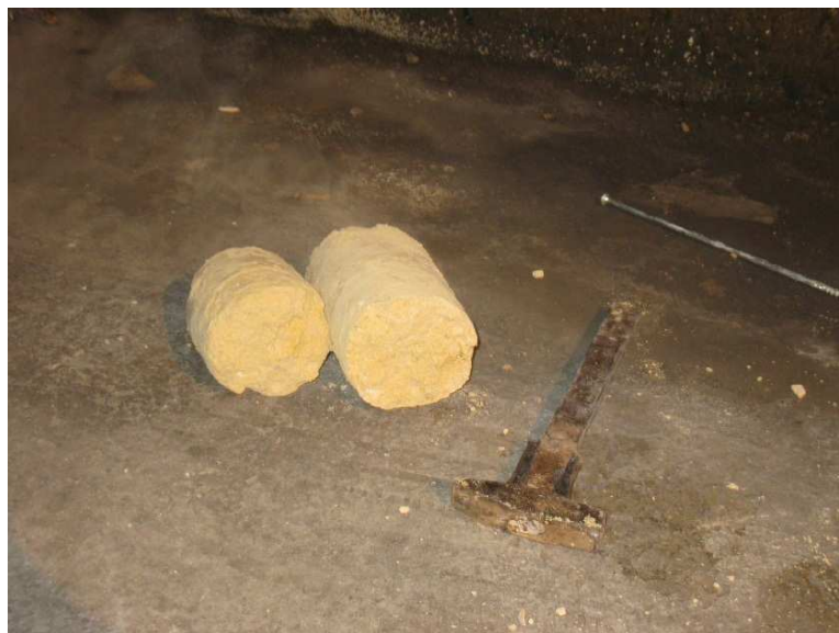
FIG. (12) – OPERAZIONI DI CAROTAGGIO (Di Bari, 2010)
