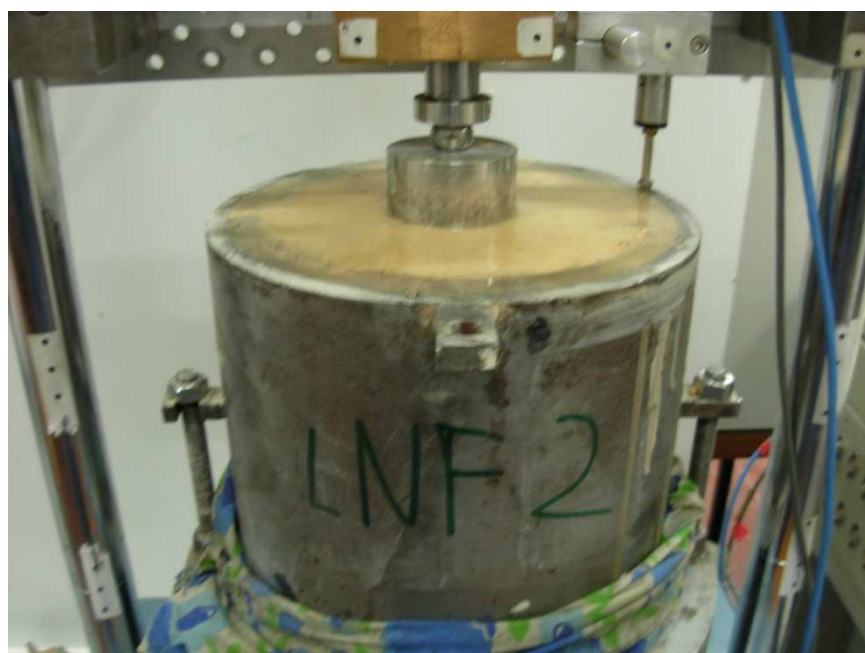
FIG. (54) – posa del campione sulla macchina di prova
