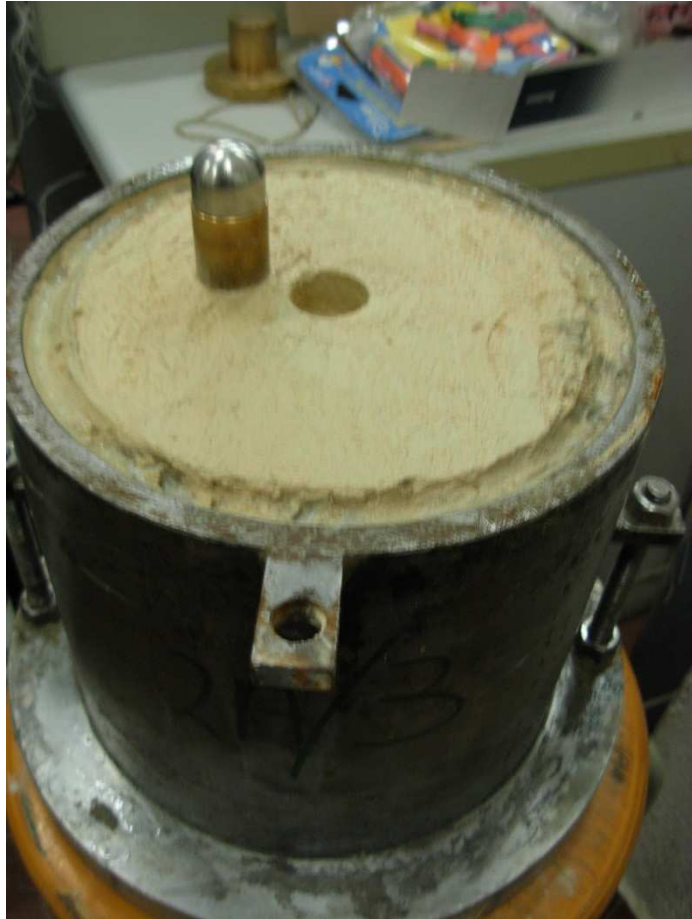
FIG. (79) – meccanismo di rottura superficiale del campione CCP-W-03-28
