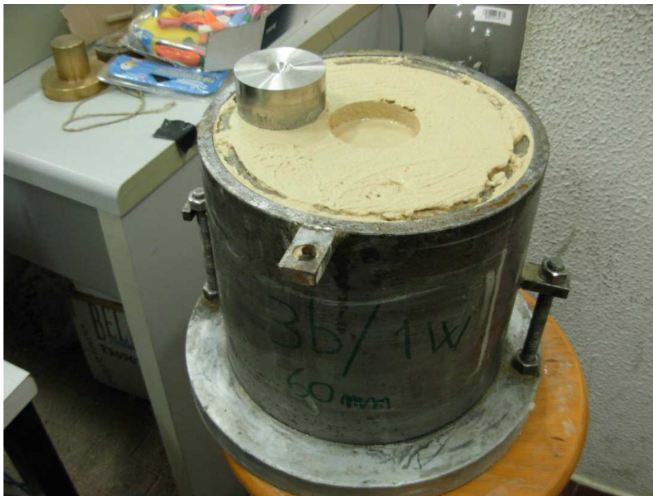
FIG. (81) – meccanismo di rottura superficiale del campione CCP-W-05-60
