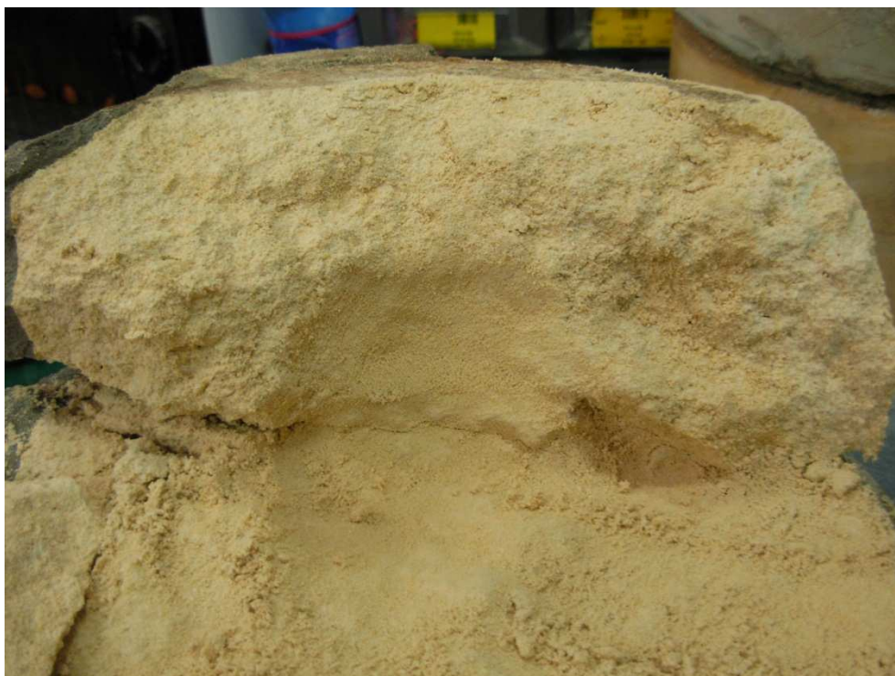
FIG. (85) – bulbo di rottura del campione CCP-D-04-60
