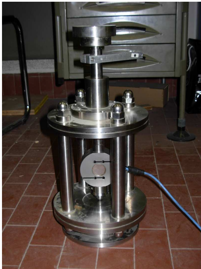
FIG. (40) – calibrazione della cella di carico
