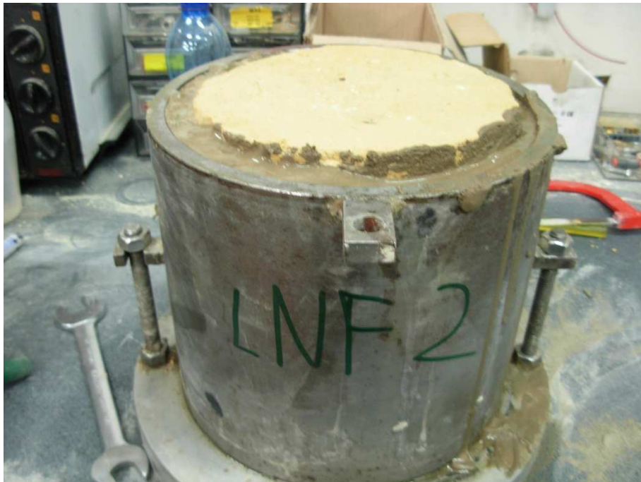
FIG. (50) – sigillatura con cemento a presa rapida
