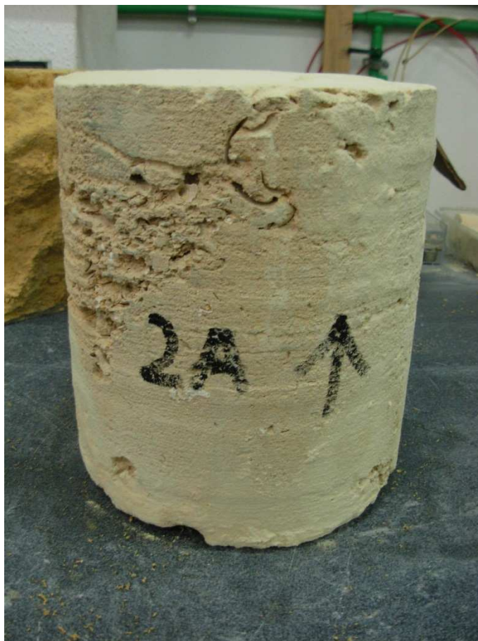
FIG. (73) – Campione CCP-W-01-60 con evidenziata la zona maggiormente porosa
