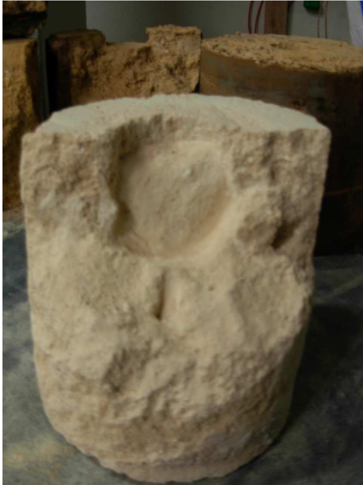
FIG. (65) – bulbo di rottura
