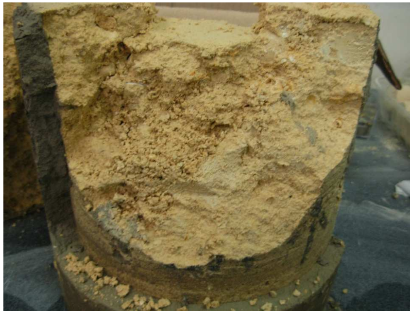
FIG. (75) – zona maggiormente porosa nel campione CCP-W-01-60
