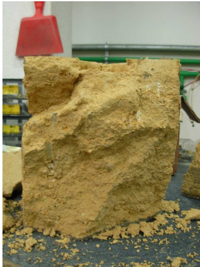
FIG. (72) – bulbo di rottura del campione CCL-W-02-60
