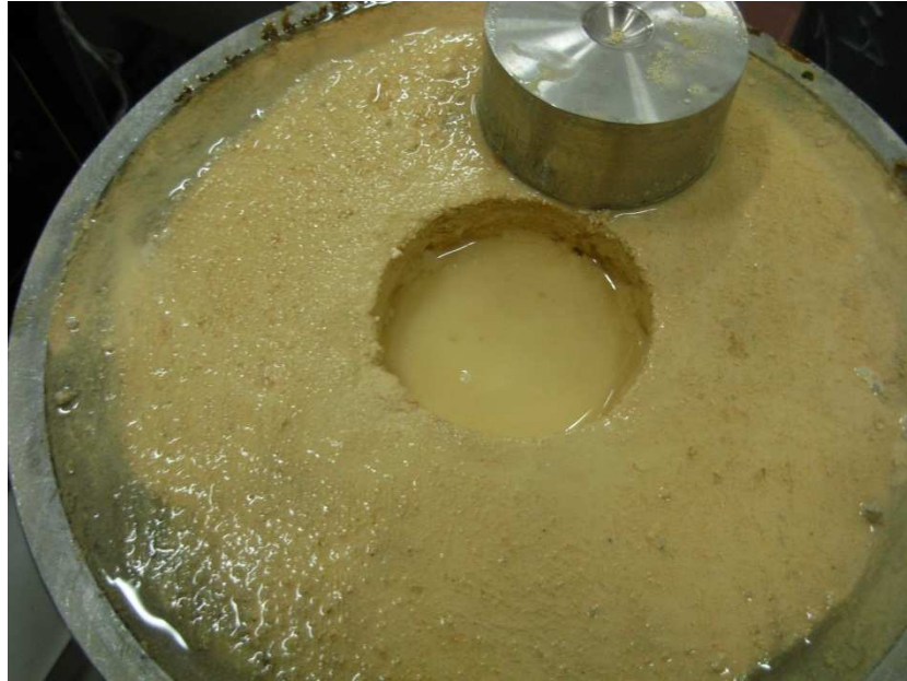
FIG. (71) – meccanismo di rottura superficiale del campione CCL-W-02-60
