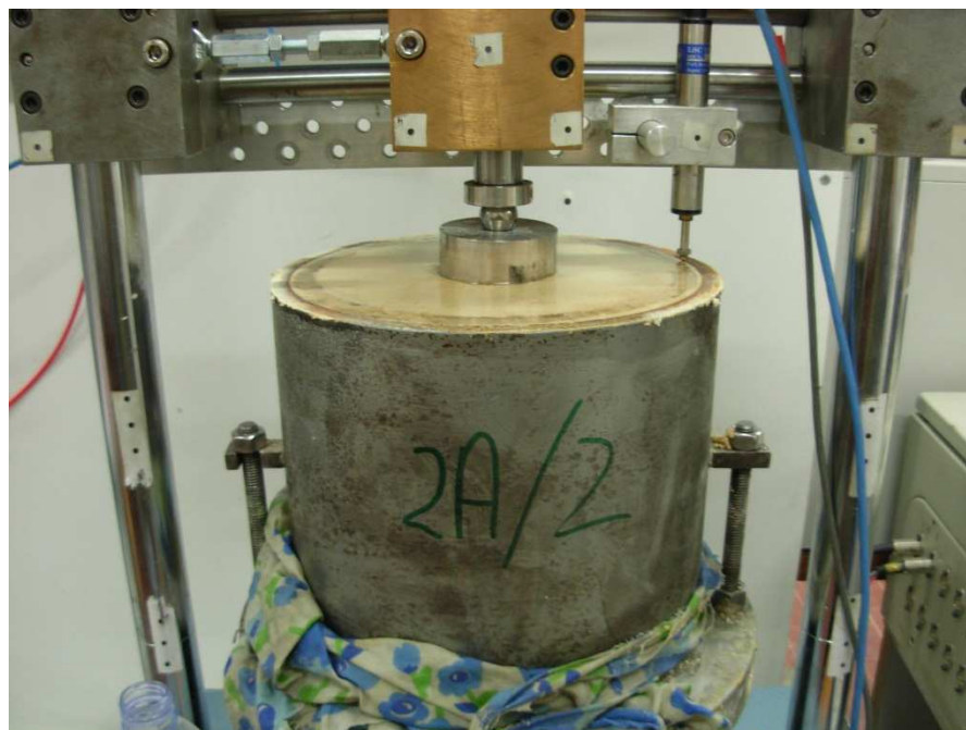
FIG. (76) – esecuzione della prova sul campione CCP-W-02-60
