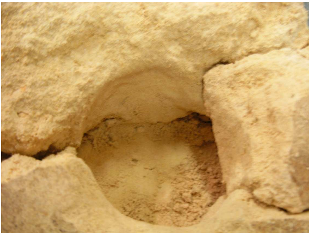
FIG. (84) – bulbo di rottura del campione CCP-D-04-60
