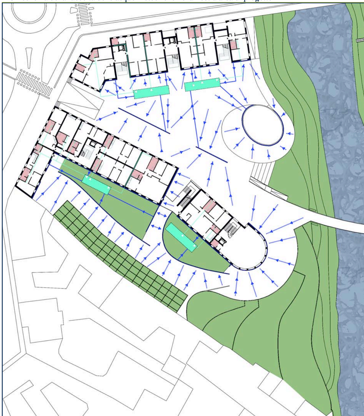
F. 52 schema della raccolta delle acque meteoriche nella nostra area di progetto
