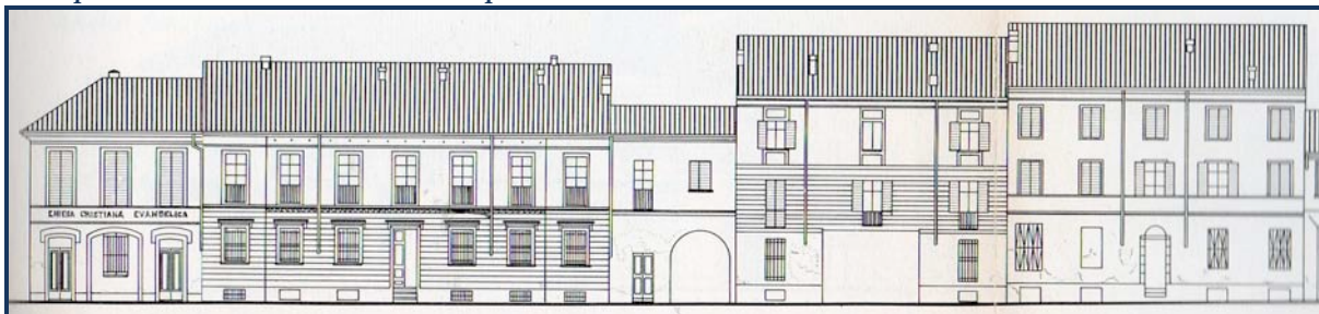
F. 43 prospetti su corso libertà tipologia casa mercantile. Si possono notare le diverse altezze dei lotti di facciate, che generano diverse articolazioni in facciata. La zoccolatura è sempre presente, come anche la corrispondenza delle finestre ai diversi piani
