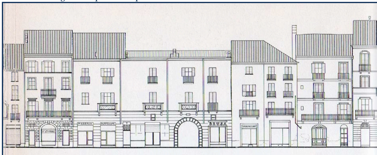
F. 42 prospetti su corso libertà tipologia casa mercantile. Si può notare la “portina” nell'ultima parte a destra dell'immagine. Le aperture dei passi carrai e le vetrine
