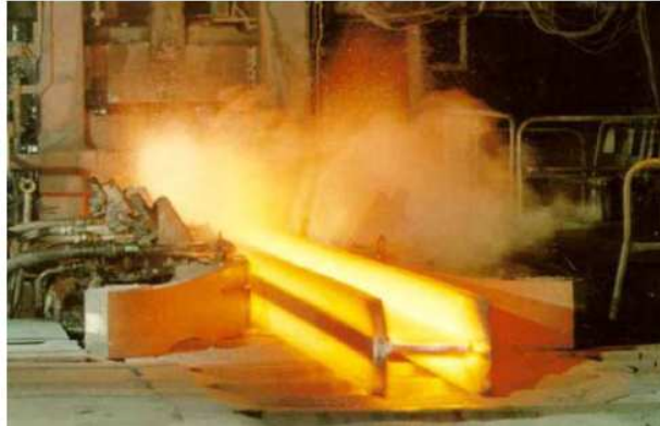
Figura 2-5: Profilato a sezione aperta in fase finale di laminazione
