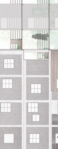
STRUTTURA: acciaio RIVESTIMENTO: lastre di lamiera inchiodata a tubolare metallico cavo
