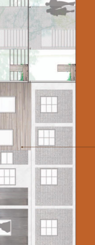
STRUTTURA: acciaio RIVESTIMENTO: lastre di lamiera inchiodata a tubolare metallico cavo
