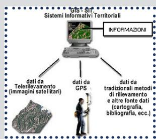
schema di funzionamento dei sistemi GIS
