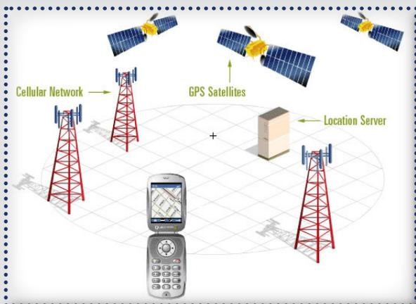
Schema di funzionamento del GPS
