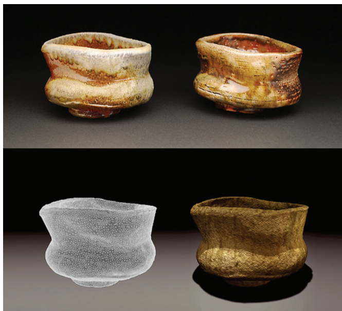
Un confronto di due oggetti di arte ceramica. L'originale è stato creato e poi duplicato usando uno scanner 3D e stampato usando la prototipazione rapida in ceramica 3D.
