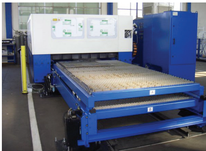
Impianto taglio al laser Trumf MOD. TC L3030 - TLF 2600
