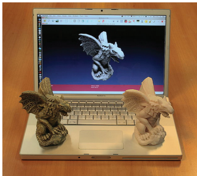
Un esempio di replica di un oggetto reale per mezzo della scansione 3D e della stampa 3D: il modello di gargoyle sulla sinistra è stato acquisito digitalmente usando uno scanner 3D
