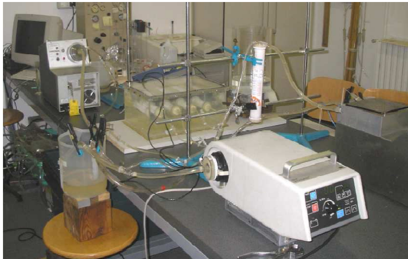
Figura 2.2: Set-up sperimentale utilizzato durante le prove di trattamento dialitico
