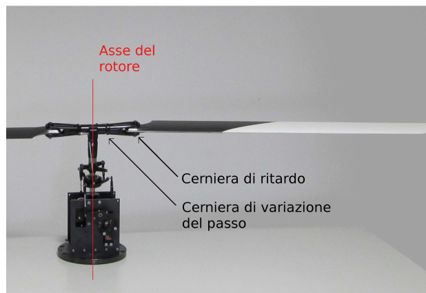
Figura 4.2: Modello di rotore. Si evidenziano le cerniere di variazione passo e di ritardo
