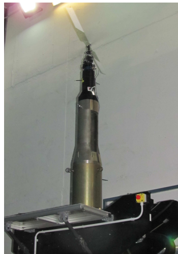
Figura 5.25: Modello di rotore durante la ripetizione della Prova 2, le pedane della struttura che ospita il motore sono aperte per valutare l'entità dell'effetto suolo.
