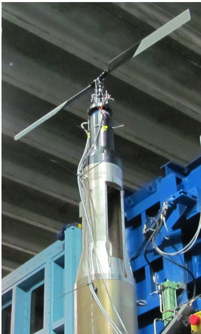
Figura 1.4: Attrezzatura di prova del modello di rotore e modello di rotore.
