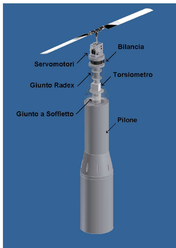
Figura 1.1: Disegno CAD dell'attrezzatura di prova del modello di rotore.
