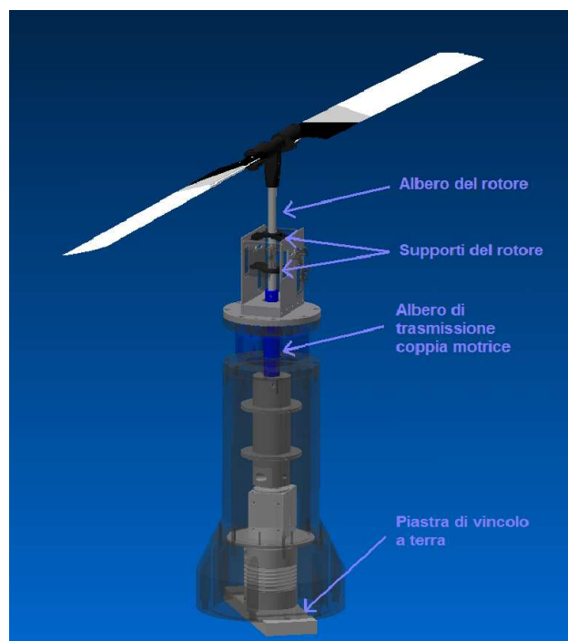
Figura 2.1: Attrezzatura di prova completa del modello di rotore: componenti coinvolte nella trasmissione e rilievo del carico assiale.
