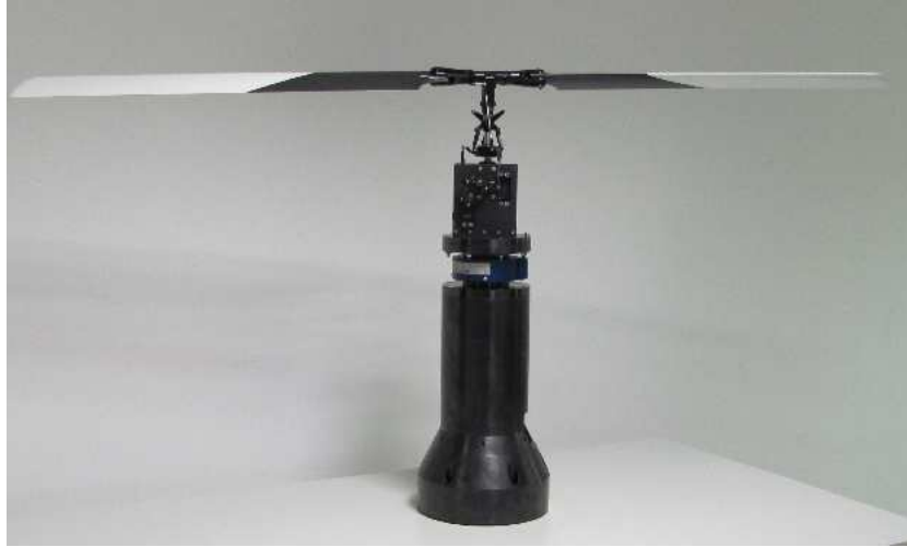
Figura 1.2: Parte superiore dell'attrezzatura di prova del modello di rotore e modello di rotore.
