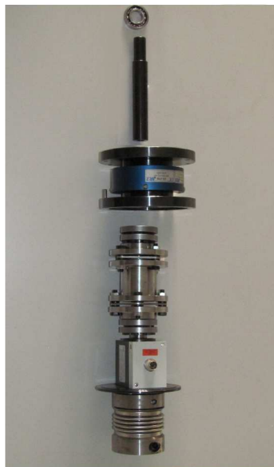
Figura 1.3: Torsionmeter con giunti di accoppiamento, bilancia estensimetrica ed albero di trasmissione della coppia motrice.
