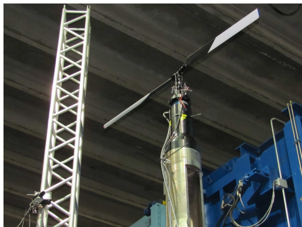
Figura 5.4: Configurazione della telecamera e della luce stroboscopica per eseguire il tracking delle pale.
