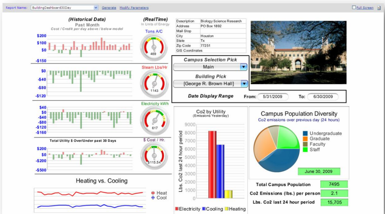
Figura 2.1 – Cruscotto di un edificio in cui si visualizza l’andamento dei consumi energetici e relativi KPI (Fonte Rockwell Automation)
