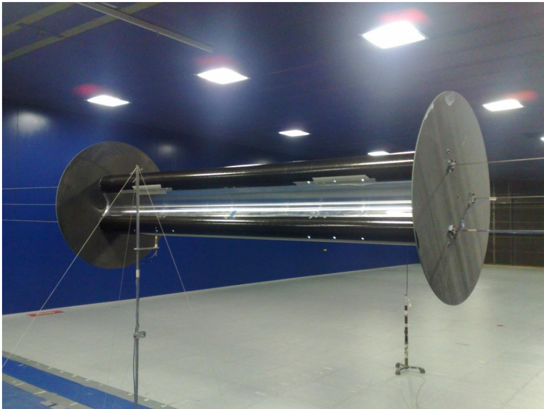
Figura 5.7: Modello della struttura utilizzato per gli esperimenti in Galleria del Vento.
