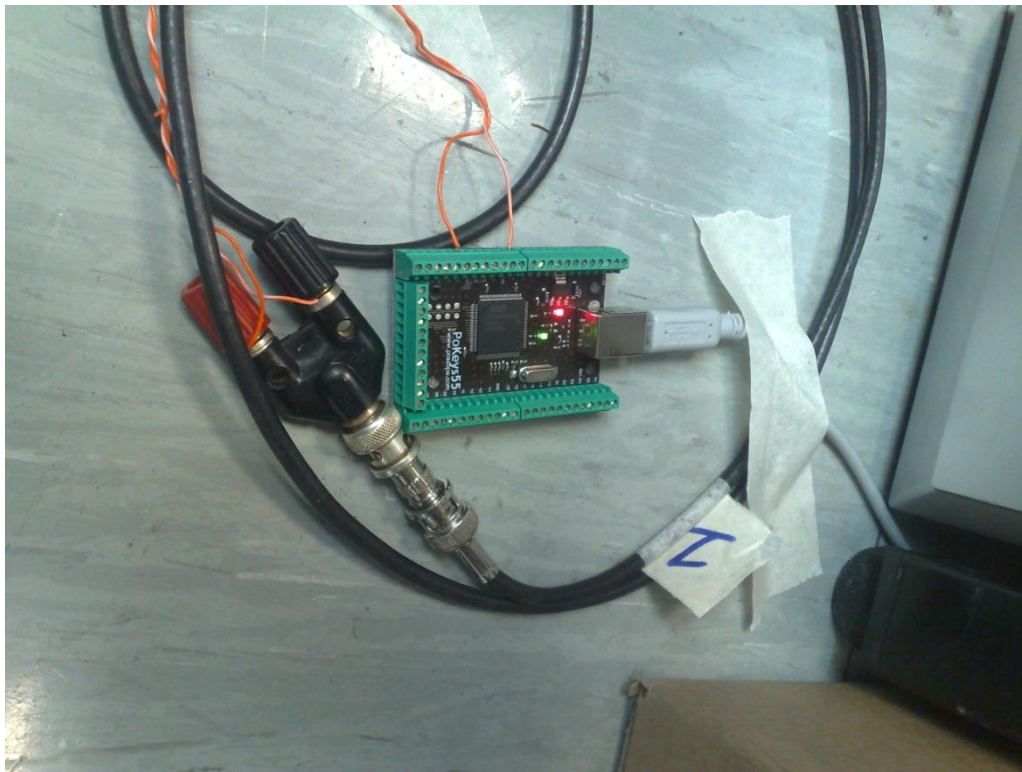
Figura 5.17: Particolare raffigurante la scheda che genera il segnale di trigger.
