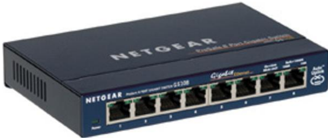
Figura 4.9: Switch Gigabit Ethernet NETGEAR ProSafe Plus GS108 a 8 porte utilizzato per la comunicazione tra il computer e le tre telecamere.
