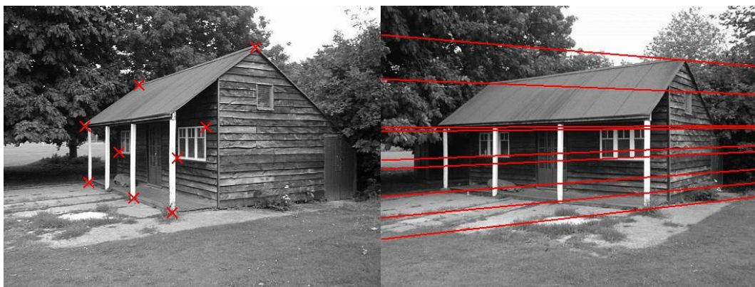
Figura 3.6: Esempio di geometria epipolare. Per ogni punto selezionato nella prima immagine sono state tracciate le rette epipolari nella seconda immagine.
