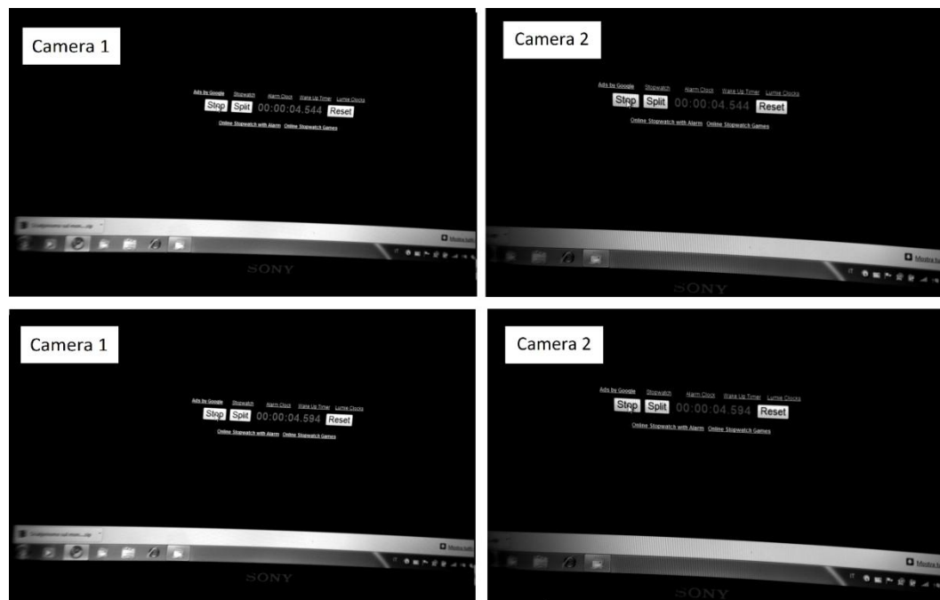
Figura 4.3: Alcune immagini acquisite durante il test del cronometro. Si nota come le immagini delle due telecamere sono acquisite in maniera sincrona.
