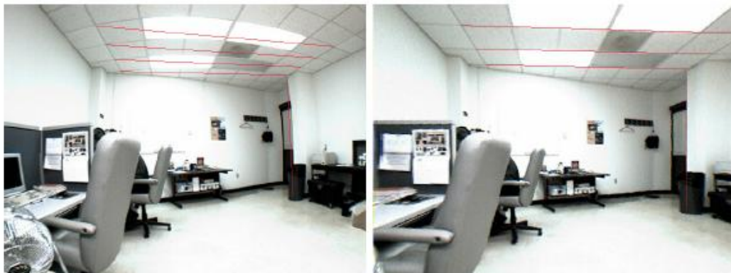
Figura 2.7: Differenza tra un'immagine soggetta a distorsioni radiali (a sinistra) e una non soggetta (a destra).
