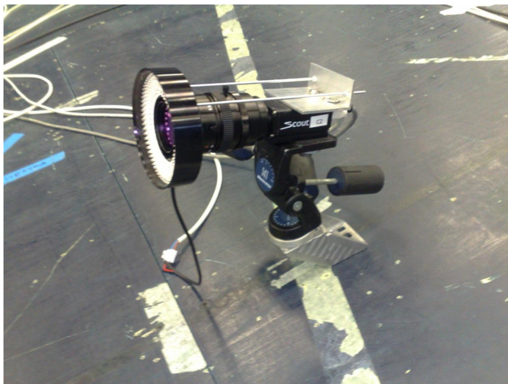
Figura 5.13: Particolare raffigurante una singola telecamera e il rispettivo illuminatore.
