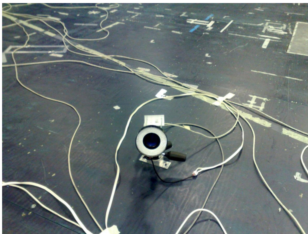
Figura 5.14: Particolare raffigurante illuminatore e filtro interferenziale di una singola telecamera.
