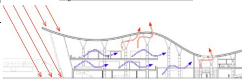
grafico 27: schema approccio bioclimatico stagione invernale ed estiva
