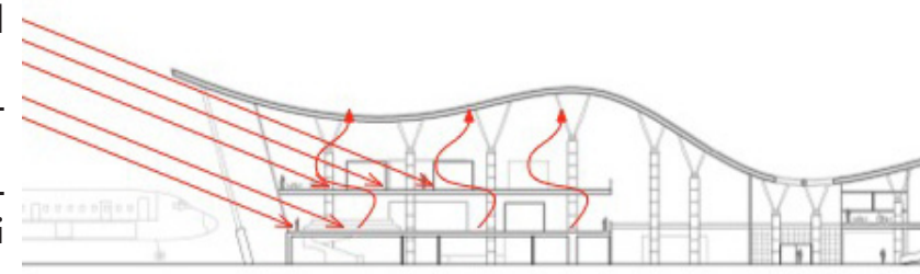
grafico 27: schema approccio bioclimatico stagione invernale ed estiva
