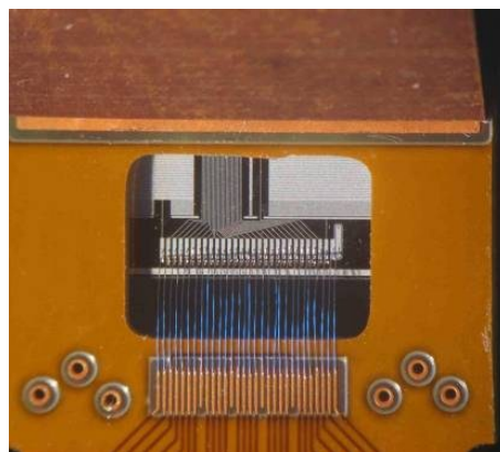
Figura 2.11 Bonding di collegamento tra Rigid-Flex ed SDD. Riferimento bibliografico n 11
