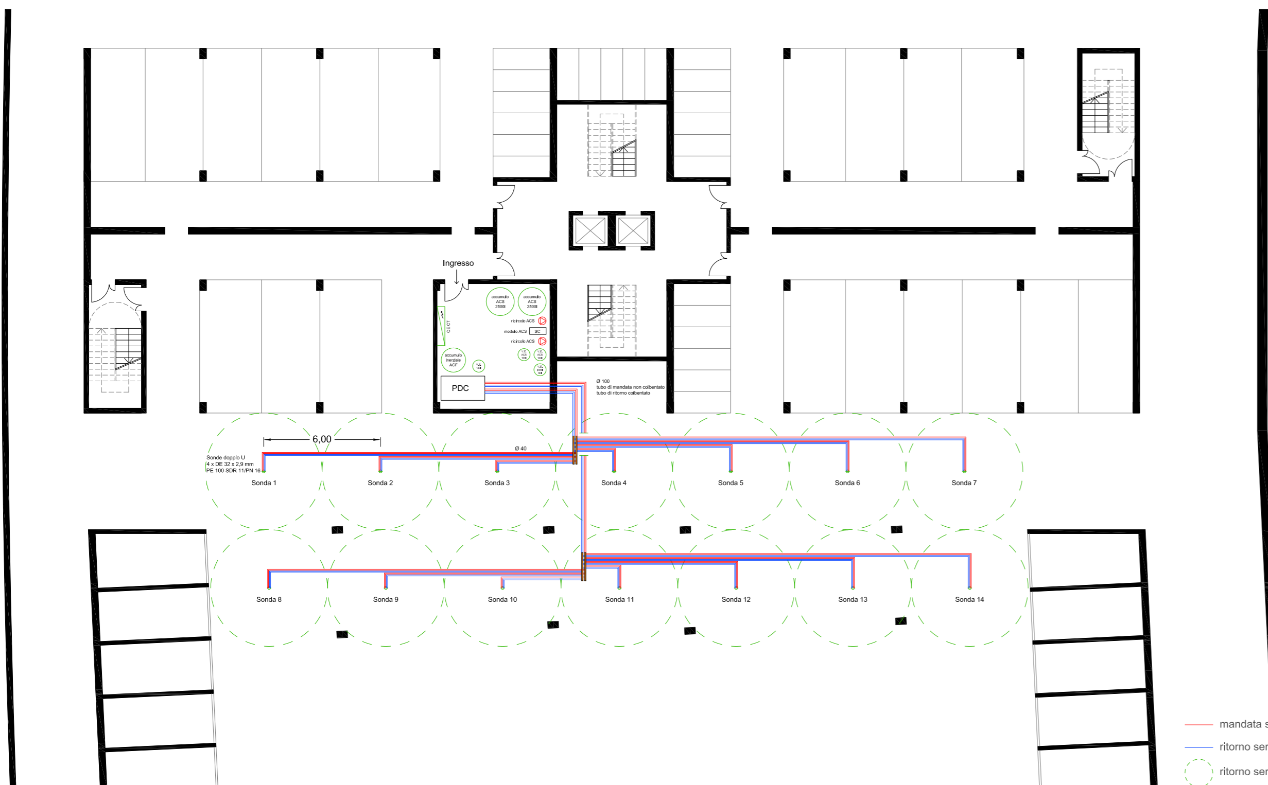
Piano interrato_sistema sonde geotermiche_scala 1:200
