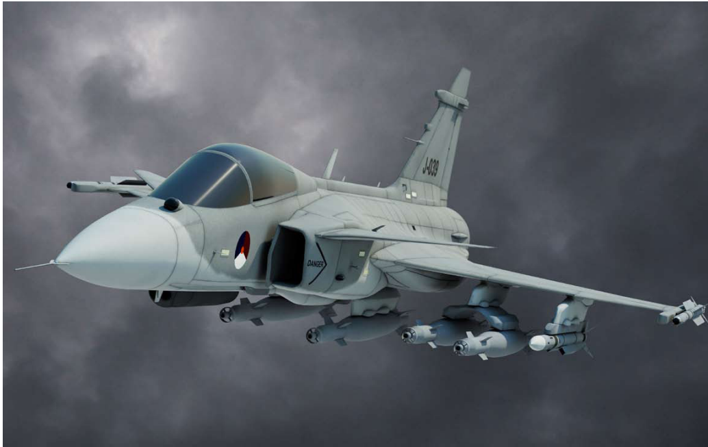
Figura 1.2. Rendering del Gripen NG, si noti come sia presente la cupola del sensore IRST sul lato sinistro del muso, assente nelle versioni meno recenti del caccia.
