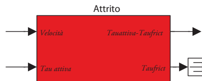
Figura 2.14. Blocco dell'attrito, l'uscita Taufric non viene più usata ed è quindi mandata in un blocco terminatore.
