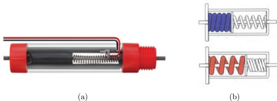
Figura 4.11: Attuatore con materiali a memoria di forma
