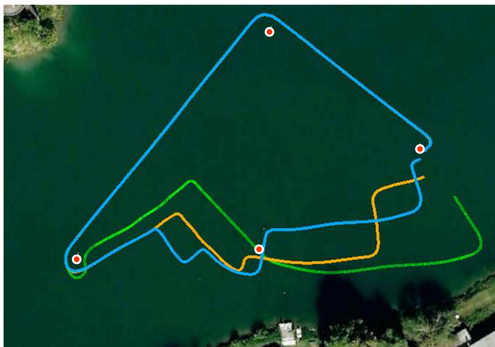
Figura 6.28 Tre tarature per la soglia del regolatore di rotta. Direzione di vento variabile
