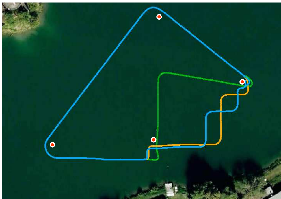
Figura 6.24 Tre tarature per la soglia del regolatore di rotta. Direzione di vento costante
