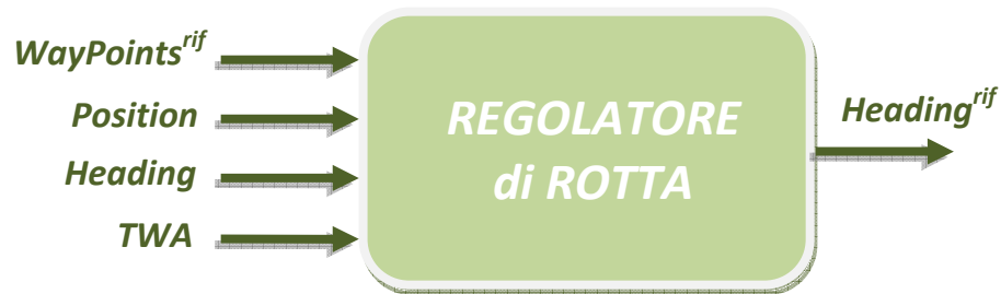
Figura 6.2 Schema di ingresso-uscita del regolatore di rotta
