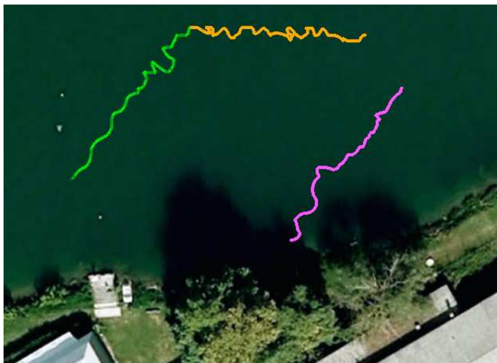
Figura 7.4 Tracciati relativi ai test effettuati sul regolatore d'imbardata
