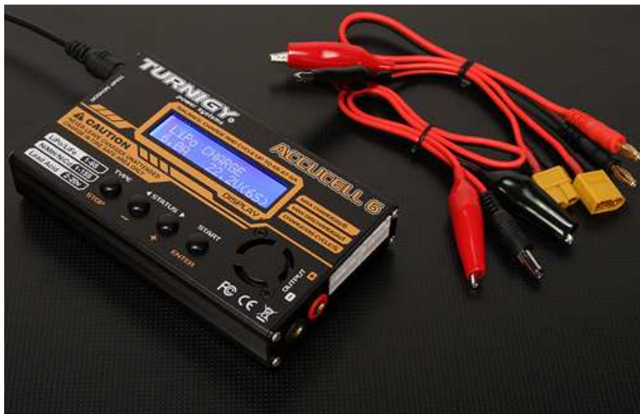
Figura 3.8 Caricatore con funzione di bilanciamento delle celle
