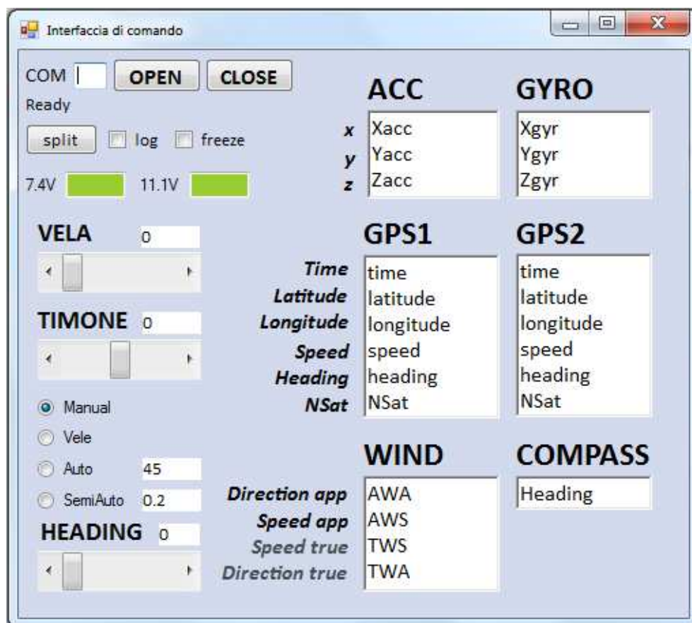
Figura 3.20 L'interfaccia di comando
