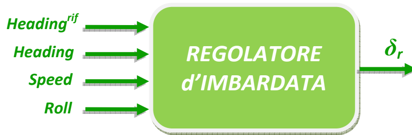
Figura 6.15 Rappresentazione d'ingresso-uscita del regolatore d'imbardata
