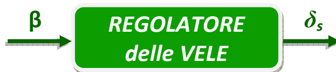
Figura 6.18 Schema d'ingresso-uscita del regolatore delle vele
