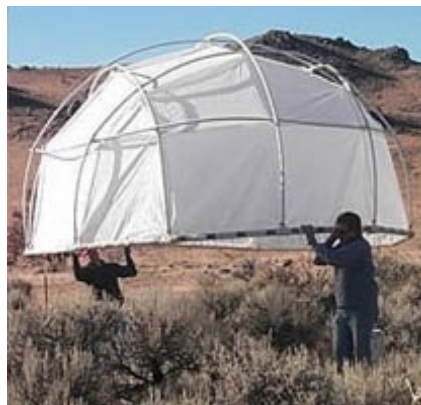
Figura 4. Camera statica a cupola impiegata dal dottor John A. Arnone per la quantificazione delle emissioni di CO 2 da terreni.
