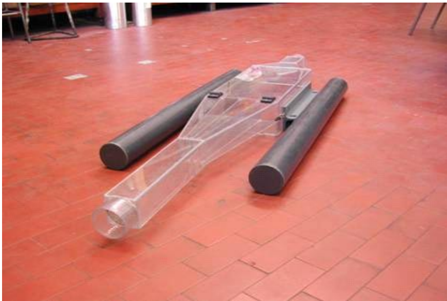
Figura 5. Wind Tunnel impiegata per il campionamento odorigeno da sorgente areale passiva liquida.
