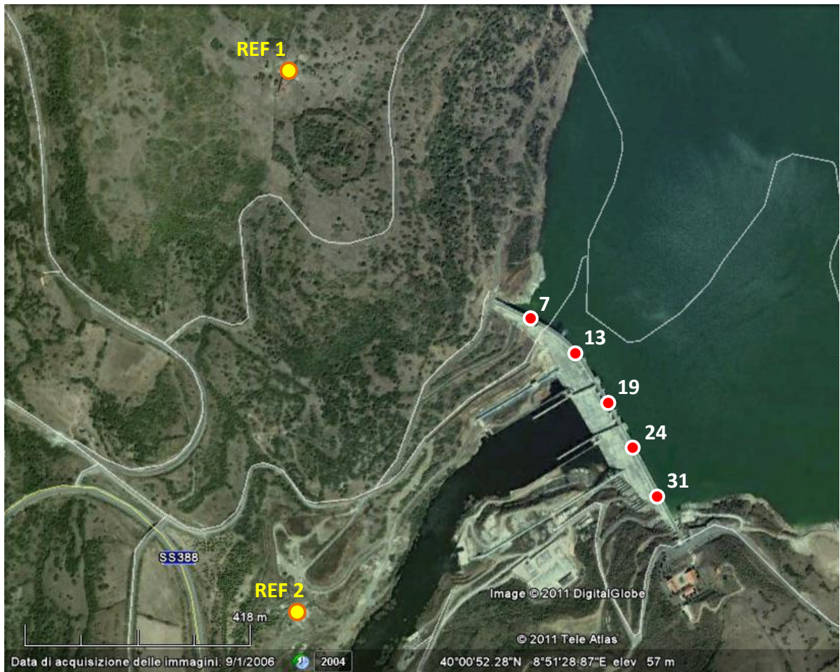
Figura 4.5 La rete di monitoraggio GNSS ipotizzata per la diga Cantoniera.
