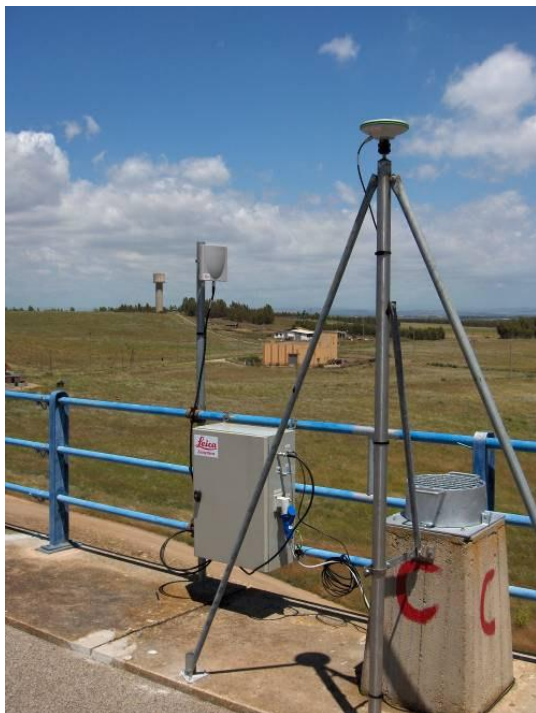
Figura 2. 4 La stazione rover installata presso il punto C. A fianco si può notare l'antenna wireless per la trasmissione dati e la centralina di controllo.
