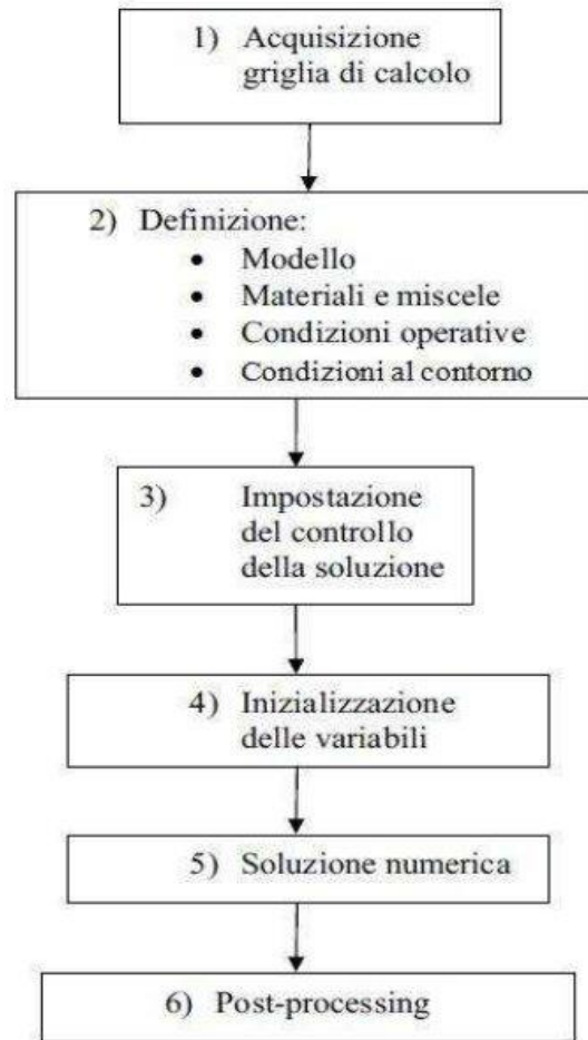
Figura 2.3 Fasi di una simulazione CFD
