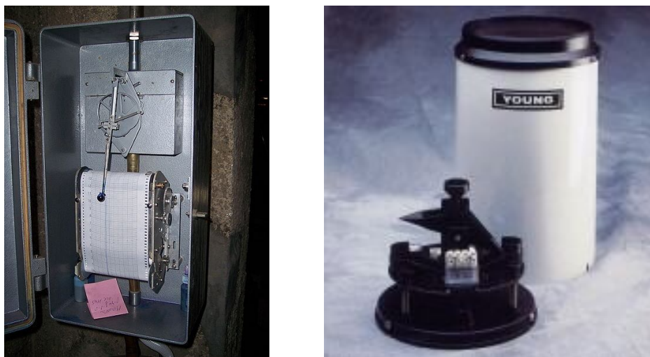
Figura 4.1: a destra l'apparato di registrazione di un pluviografo analogico (SIAP UM8150), a sinistra esempio di un pluviometro a vaschette.
