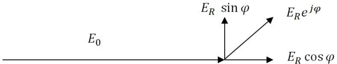
Figura 2.2 Modulazione di ampiezza e frequenza del campo elettrico di un LASER sottoposto a retro iniezione ottica
