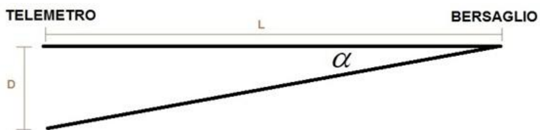
Figura 1.10 Schema di principio di un telemetro a triangolazione
