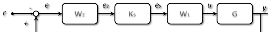
Figura 9.23: Struttura di controllo alternativa che opera su errori fisici fra le variabili ed i riferimenti.
