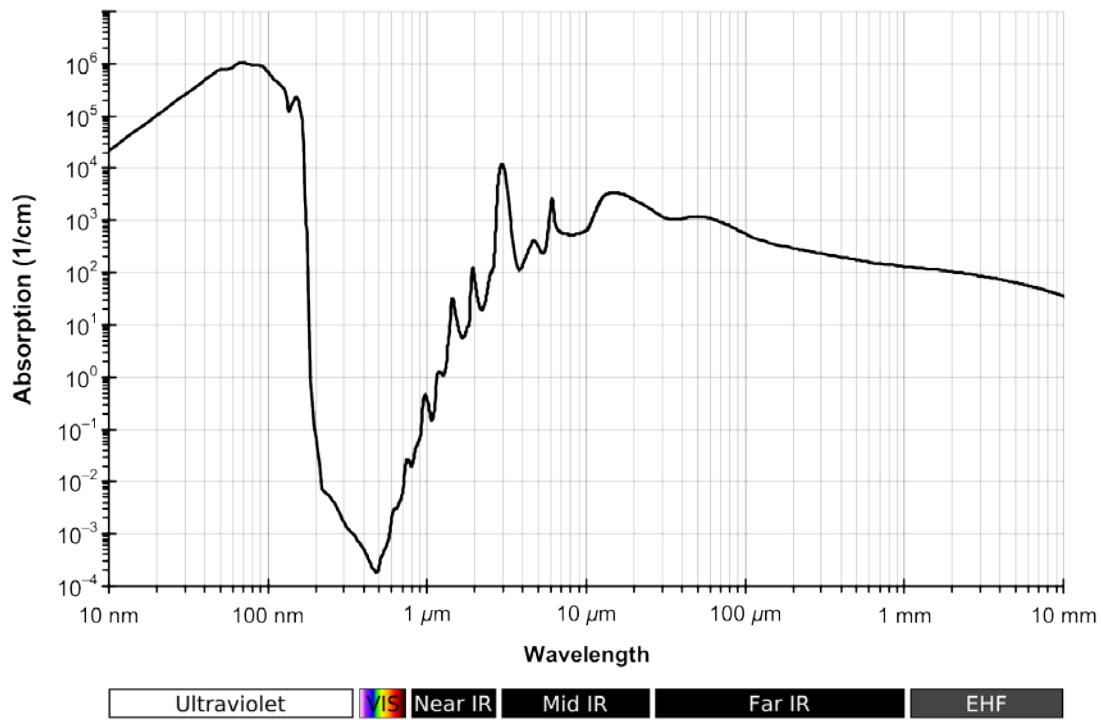
Figura 3.1 Grafico dello spettro di assorbimento dell'acqua in base alla lunghezza d'onda
