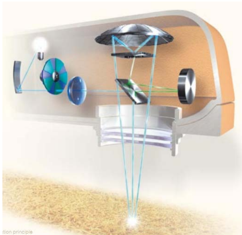
Figura 3.2 Schema di un misuratore di umidità ottico in commercio
