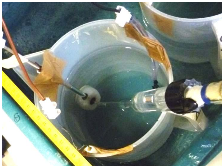
Figura 3.15 – Misura di potenziale con elettrodo AAC in capillare di Luggin.
