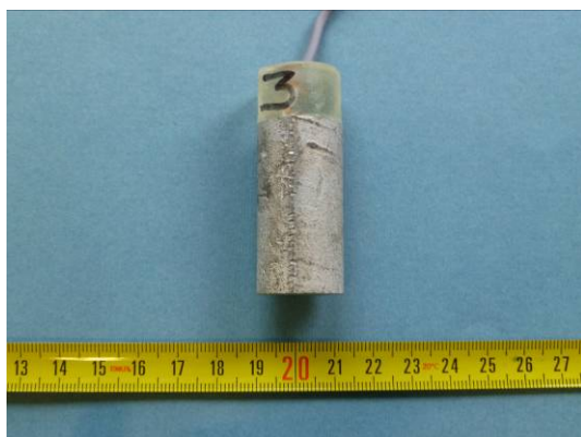
Figura 4.4a – Anodo prima della prova.
