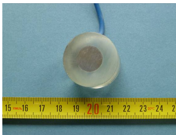
Figura 3.1 – Provino d'acciaio al carbonio ( working ).
