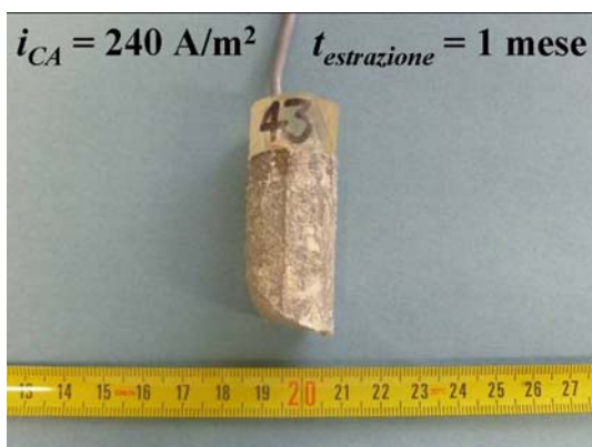
Figura 4.4c – Anodo della Serie B dopo pulitura.
