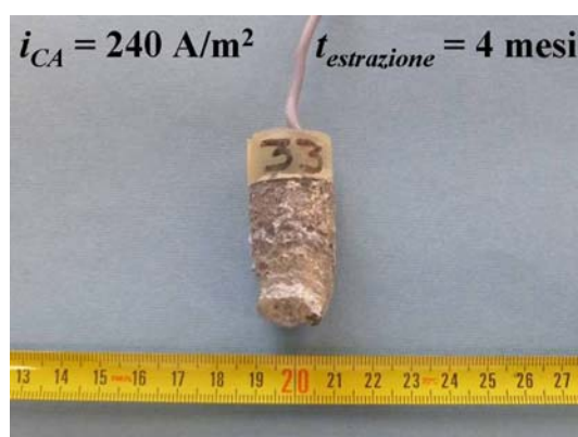
Figura 4.4f – Anodo della Serie E dopo pulitura.
